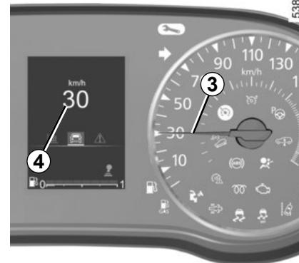
**Indicateurs de vitesse 3 et suivant véhicule, 4**
