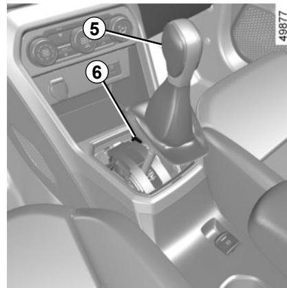
**À la mise en route**, dans le cas où le levier est bloqué sur **P** alors que vous appuyez sur la pédale de frein (panne de la batterie par exemple), il y a la possibilité de libérer manuellement le levier pour débloquer les roues motrices. Pour cela, déclipsez la base du soufflet et enfoncez le bouton poussoir **6** et appuyez simultanément sur le bouton **5** du levier afin de déverrouiller le levier et de passer à la position **N**.
