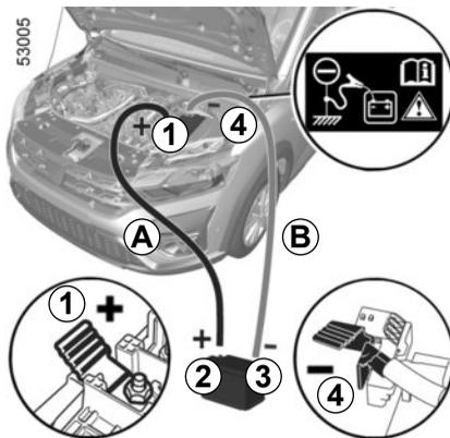
Fixez le câble positif (+) **A** sur la borne (+) **1** de la batterie déchargée, puis sur la borne (+) **2** de la batterie fournissant le courant.
