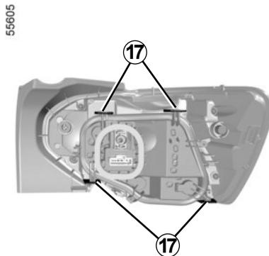
Tirez les languettes **17** pour déclipper le porte-lampes.
