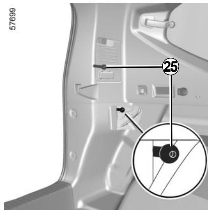
Dévissez les vises **25** et **26** (à l'aide d'un outil type tournevis), puis dégagez le bloc des feux arrière par l'extérieur du véhicule.
