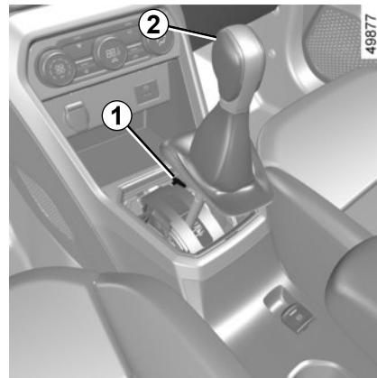
**À la mise en route**, dans le cas où le levier est bloqué sur **P** alors que vous appuyez sur la pédale de frein (panne de la batterie par exemple), il y a la possibilité de libérer manuellement le levier pour débloquer les roues motrices. Pour cela, déclipsez la base du soufflet et enfoncez le bouton poussoir **1** et appuyez simultanément sur le bouton **2** du levier afin de déverrouiller le levier et de passer à la position **N**.
