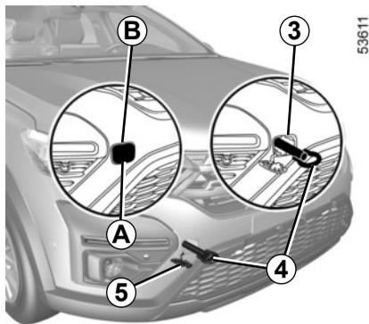
Utilisez exclusivement les points de remorquage avant 3 et arrière 7 (jamais les tubes de transmission ou toute autre partie du véhicule). Ces points de remorquage ne peuvent être utilisés qu'en traction. En aucun cas, ils ne doivent servir pour soulever directement ou indirectement le véhicule.
