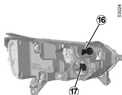
Repérez le bon positionnement de la lampe avant le démontage pour la positionner correctement lors du remontage.
