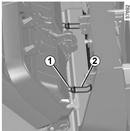
Retournez les sièges arrière de troisième rangée (assise vers l'avant et appuis-tête vers le haut). Positionnez-les contre les sièges arrière de deuxième rangée, crochet **1** sur le crochet **2**.
