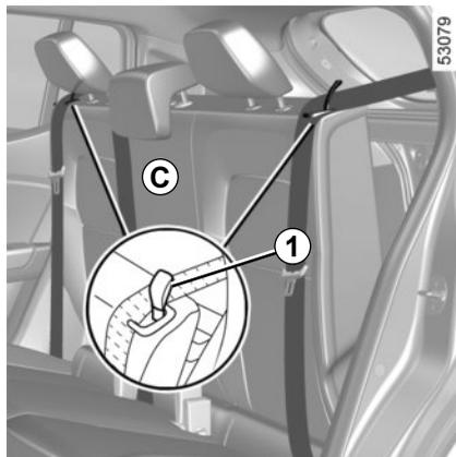
Suivant véhicule, pour déverrouiller la banquette **C**, tirer en même temps les languettes **1** de déverrouillage de l'intérieur.
