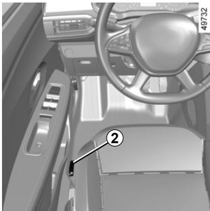
Suivant véhicule, tirez le levier **2**, pour déverrouiller la trappe à carburant **A**. Ouvrez-la puis dévissez le bouchon de réservoir à carburant **1**.
