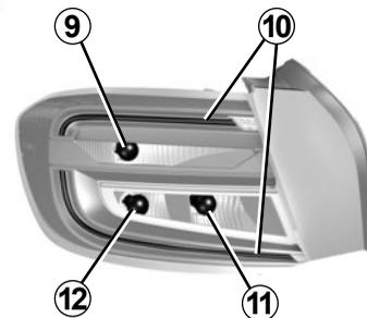
**9** Feu de stop ou, suivant véhicule, de position/de stop
