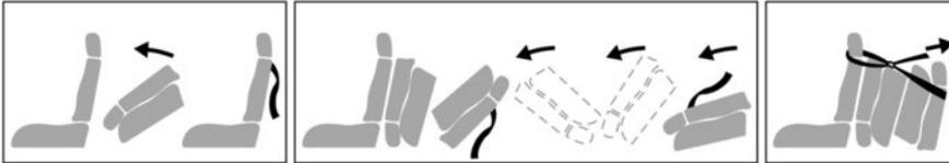
Les deux rangées de sièges arrière peuvent être regroupées afin de libérer un maximum de surface de chargement à l'arrière du véhicule.
