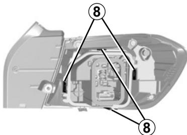
Tirez les languettes **8** pour déclipper le porte-lampes.
