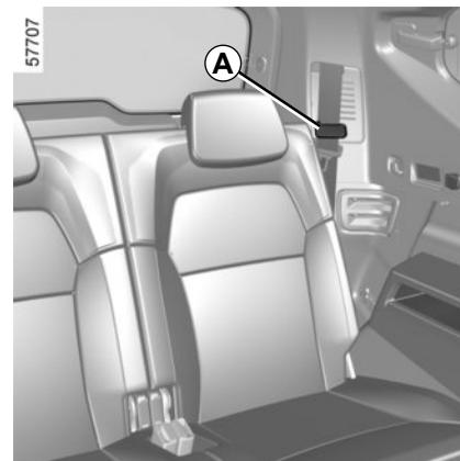
Lors de la manipulation des sièges arrière de troisième rangée, la sangle de ceinture **17** doit être impérativement fixée au crochet **A** pour ne pas endommager la sangle ou le cache-bagages (lorsque le véhicule en est équipé).
