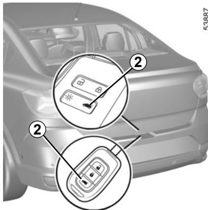
**Nota** : dans des conditions climatiques très froides, l'ouverture automatique peut ne pas fonctionner si les joints de la porte sont gelés.
