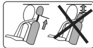
La position de l'appui-tête complètement abaissée (position C) est une position de rangement : elle ne doit pas être utilisée lorsqu'un passager est assis.
