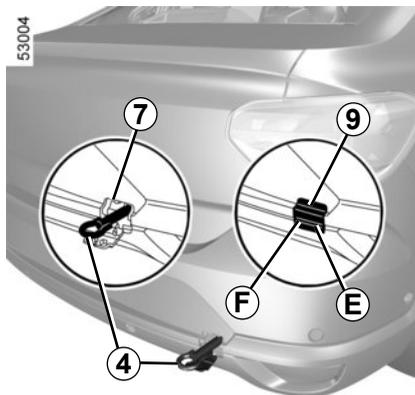
Vissez l'anneau de remorquage **4** au maximum : dans un premier temps, à la main jusqu'en butée, puis terminez en bloquant à l'aide de la clé de roue.
