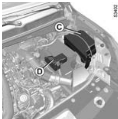
Bezpieczniki w skrzynkach C i D w komorze silnika
