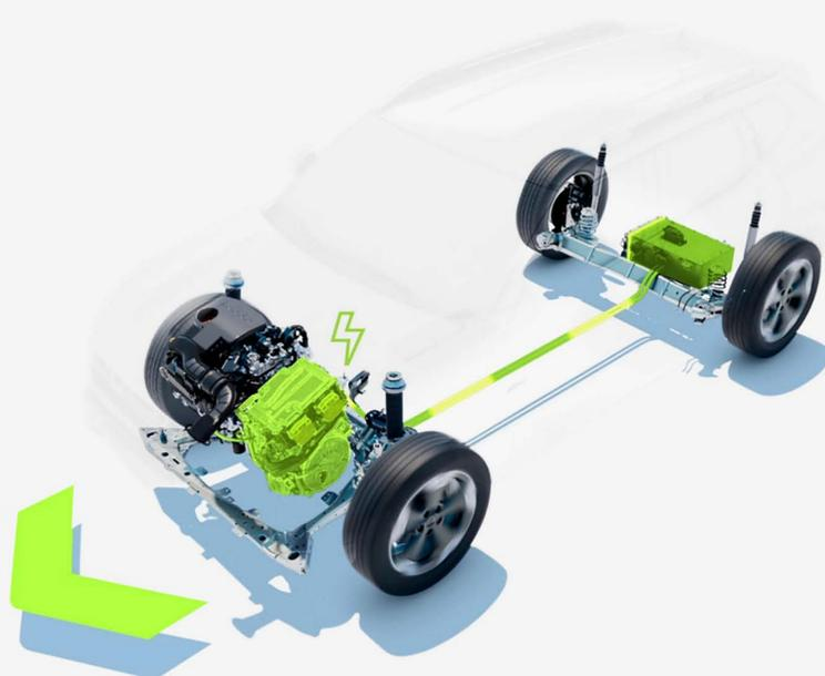
**A bateria recarrega-se em andamento, durante as fases de travagem e de desaceleração.**
