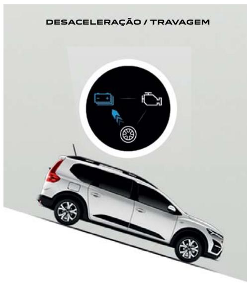
**OS MOTORES ELÉTRICOS CARREGAM A BATERIA**
