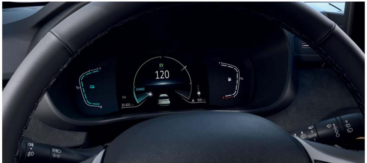
QUADRO DE INSTRUMENTOS DE 7" A CORES COM INFORMAÇÃO SOBRE O MODO DE CONDUÇÃO
