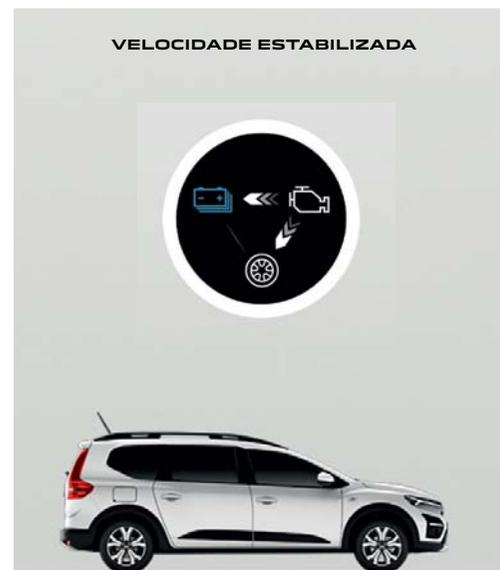
**O MOTOR DE COMBUSTÃO INTERNA TRABALHA À VELOCIDADE IDEAL PARA ACIONAR AS RODAS E CARREGAR A BATERIA**
