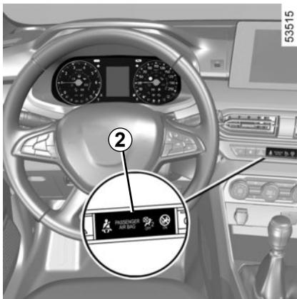
**Para reativar o airbag: com o veículo parado e a ignição desligada**, empurre e rode o interruptor para a **1** posição **ON**.
