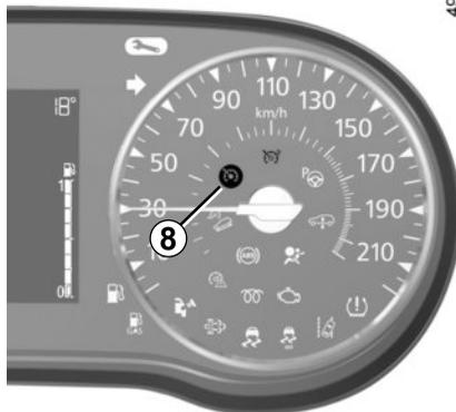
Consoante o veículo, o testemunho 8 desaparece para confirmar a entrada no modo de suspensão.
