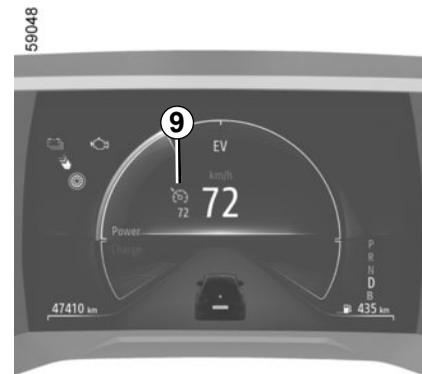
Quando a velocidade é recuperada, a ativação do regulador de velocidade é confirmada através da apresentação da velocidade de regulação a branco e, consoante o veículo, do testemunho 8.
