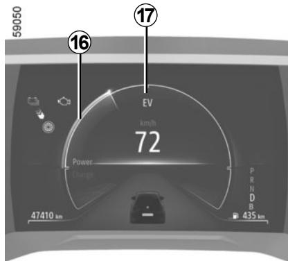
**Testemunho do modo de funcionamento elétrico 17**
