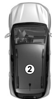
**Com o motor desligado** e se, depois de ter aberto e fechado uma porta, o cartão já não estiver na zona **2**, a mensagem «Cartão não-detetado» alerta o condutor de que o cartão já não se encontra no veículo. Isto permite evitar, por exemplo, que o veículo se desloque depois de um passageiro sair com o cartão.
