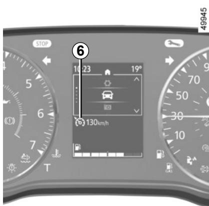
O testemunho **6** ou, consoante o veículo, os testemunhos verdes **7**, **8** ou **9** desaparecem do quadro de instrumentos para confirmar que a função está desativada.
