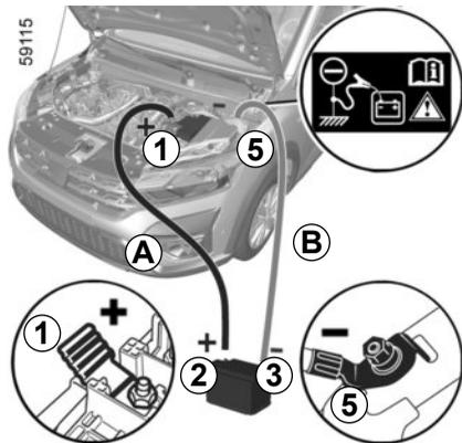
Ponha o motor a trabalhar normalmente. Assim que o motor arrancar, desligue os cabos **A** e **B** pela ordem inversa **4 - 3 - 2 - 1** ou, consoante o veículo, **5 - 3 - 2 - 1**.
