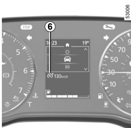
Se o limitador de velocidade estiver no modo de suspensão, uma pressão no interruptor **3** reativará a função sem que seja tomada em consideração a velocidade memorizada: será tomada em consideração a velocidade a que o veículo circula nesse momento.
