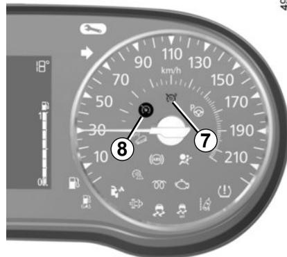
Consoante o veículo, se tentar ativar a função a uma velocidade inferior a 30 km/h, a mensagem “Veloc. inválida” será apresentada e a função permanecerá inativa.
