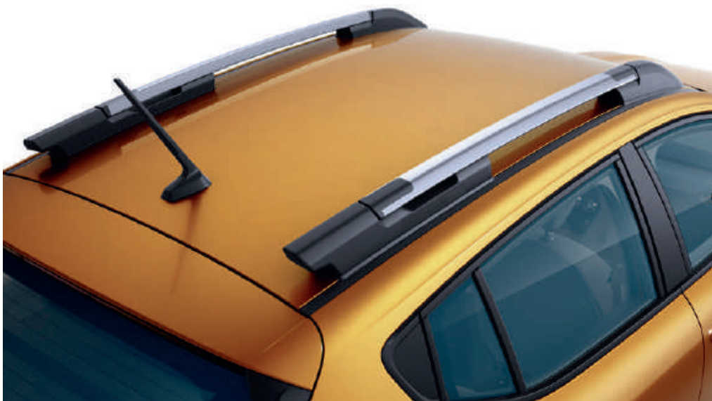
BARE DE PAVILION LONGITUDINALE
