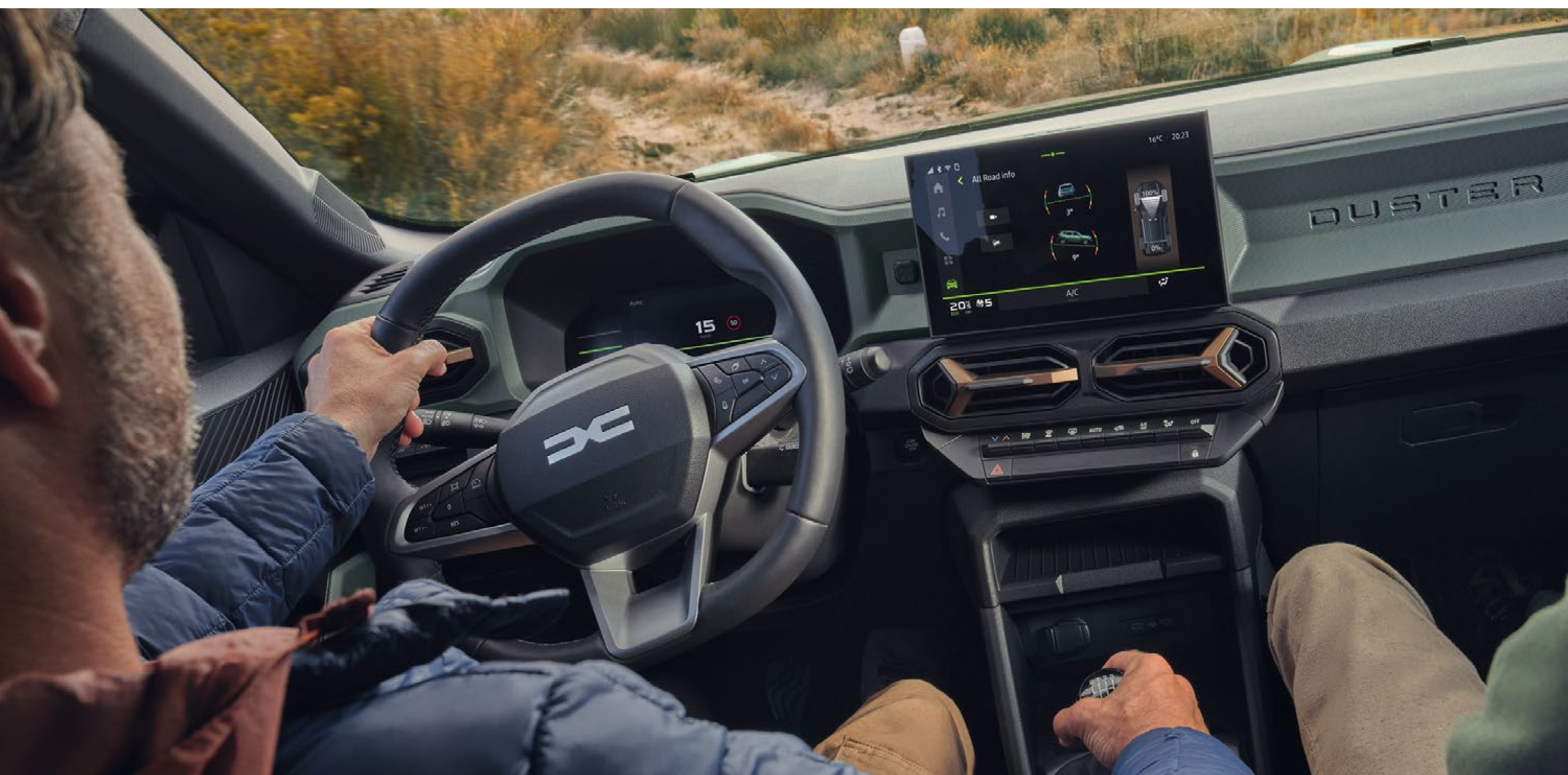
Ecran tactil cu informații 4x4: unghiuri de înclinare și distribuirea cuplului
