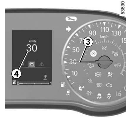
Vitezometre 3 și, în funcție de vehicul, 4
