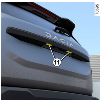
Lampă placă de înmatriculare 11 (LED)
