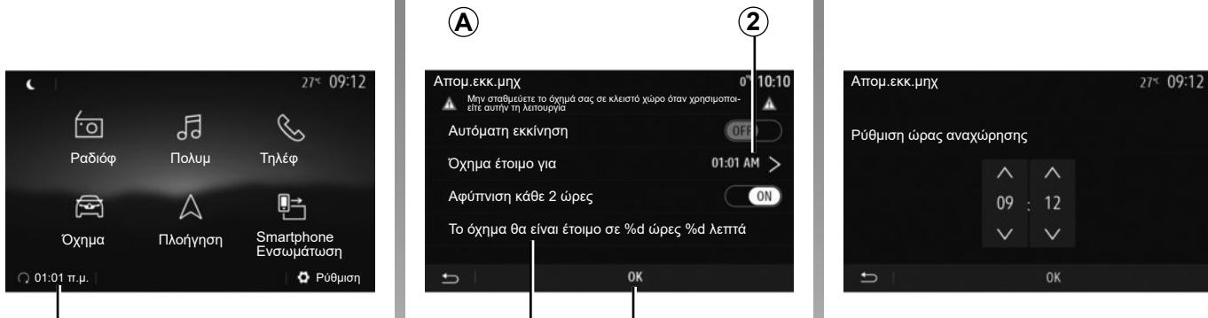
Αυτή η λειτουργία, εάν υπάρχει, επιτρέπει τον προγραμματισμό εκκίνησης του κινητήρα από απόσταση, για θέρμανση ή εξαερισμού της καμπίνας επιβατών έως και 24 ώρες πριν από τη χρήση του αυτοκινήτου.
