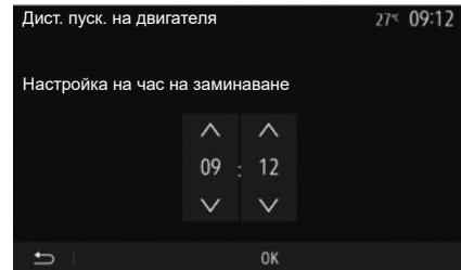
Ако е инсталирана, тази функция ви позволява също да програмирате двигателя да бъде стартиран дистанционно, за да се затопли или провери купето до 24 часа, преди да използвате автомобила. Регулирайте необходимото ниво на отопление (температура, размразяване), преди да програмирате функцията. Конфигурирането и програмирането се извършват през мултимедийния дисплей.
