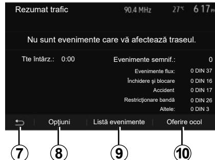
Ecranul vă indică diversele evenimente care apar pe ruta dumneavoastră. Sistemul vă va indica durata întârzierilor pe care aceste incidente le adaugă rutei dumneavoastră. Apăsați pe 8 pentru a modifica parametrii de afișare a evenimentelor. Apăsați pe 10 pentru a face un ocol, pe 9 pentru a accesa opțiunile de trafic (consultați capitolul „Reglaje de navigare”) sau pe 7 pentru a reveni la navigare.
