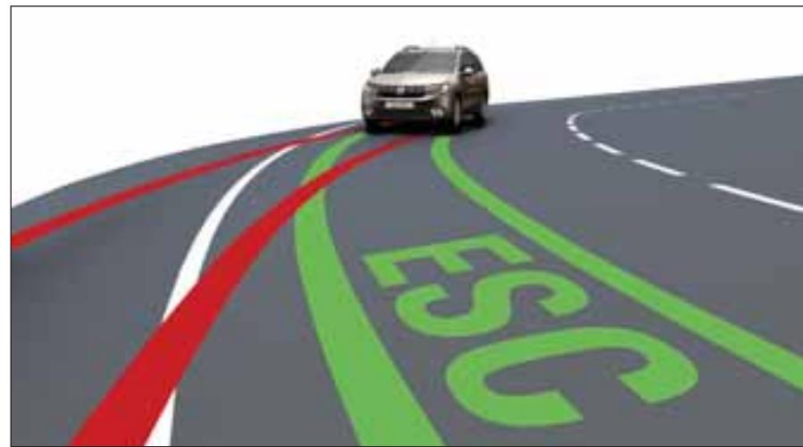
**Sistem ESC**: stabilizuje smer vozila u slučaju gubitka prijanjanja pneumatika tokom kočenja, tako što deluje na raspodelu kočione sile i broj obrtaja motora.
