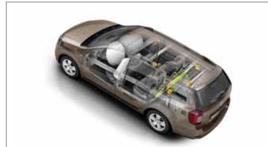
**Zaštita:** ojačana karoserija, prednji čoni i bočni vazdušni jastuci i sistem pričvršćivanja Isofix na zadnjim bočnim sedištima.
