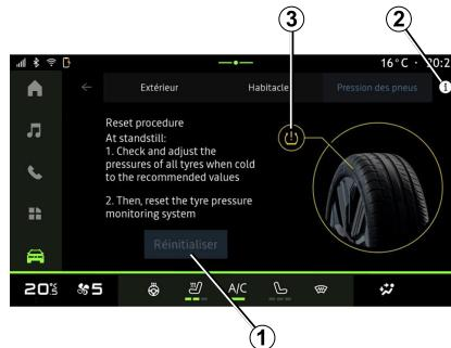
V multimediamiálnom systéme si môžete skontrolovať hodnoty tlaku v pneumatikách.
