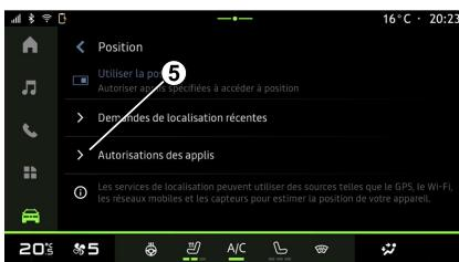
V menu „Nastavenia“ vyberte možnosť „Poloha“, potom Oprávnenia aplikácií **5** a nakonfigurujte oprávnenia na zisťovanie polohy pre aplikácií nainštalované v multimedialiálnom systéme.
