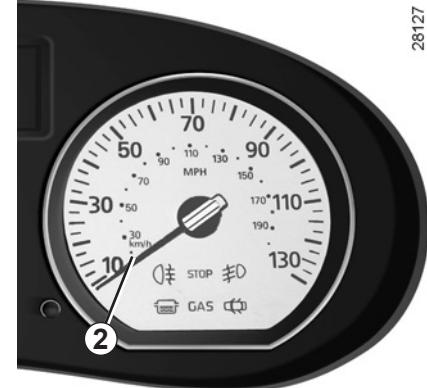
Tachometer 2 Dvojitá stupnica na zobrazenie rýchlosťi (míle/h a km/h)
