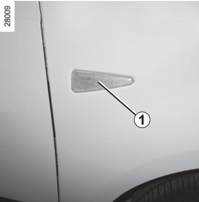
Odopnite bliakač 1 (pomocou plochého nástroja, napríklad skrutkovača).
