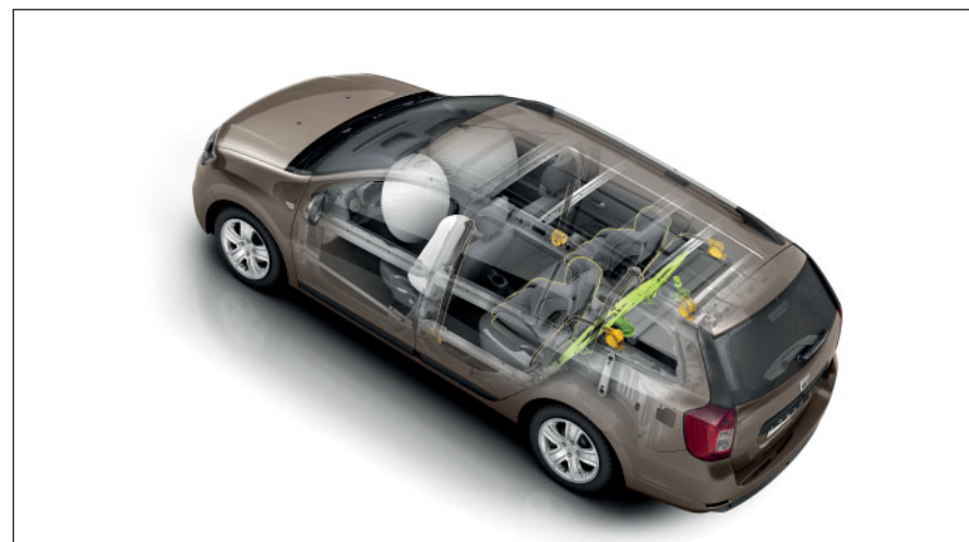
Ochrana pasažierov: robustná konštrukcia karosérie, čelné a bočné airbagy v prednom rade a úchyty Isofix na bočných sedadlách v zadnom rade.
