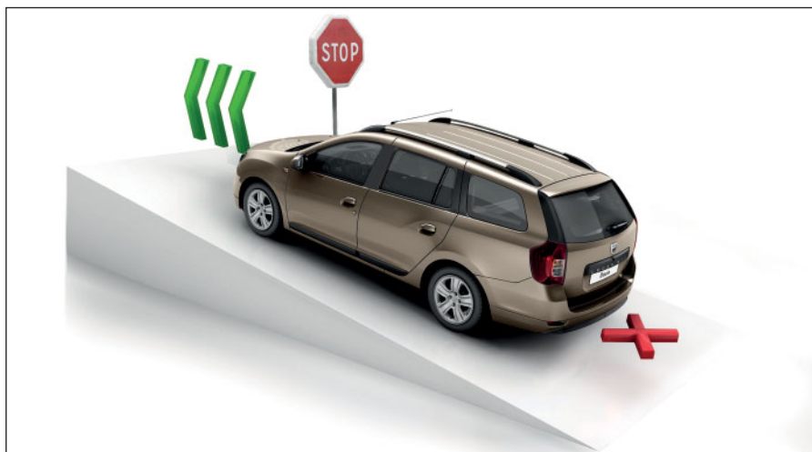
Asistent rozjazdu do kopca: tento systém umožňuje bezpečný a pokojný rozjazd vo svahu.
