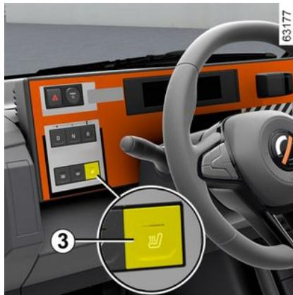
Con il contatto inserito, è possibile attivare il sedile termico (sedile del conducente) tramite il quadro della strumentazione:
