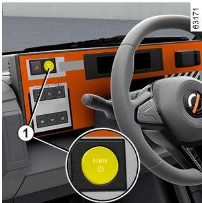
Per sbloccare il piantone dello sterzo, ruotare leggermente il volante premendo il pulsante di avviamento del veicolo **1**.
