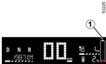
In caso di esaurimento completo della batteria di trazione, il livello di carica **1** indicato sul quadro della strumentazione sarà vuoto.
