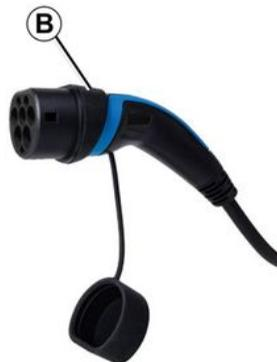
Questo cavo è specifico per il veicolo ed è previsto per il collegamento alle prese a muro o alle colonnine pubbliche per permettere la ricarica standard della batteria di trazione.
