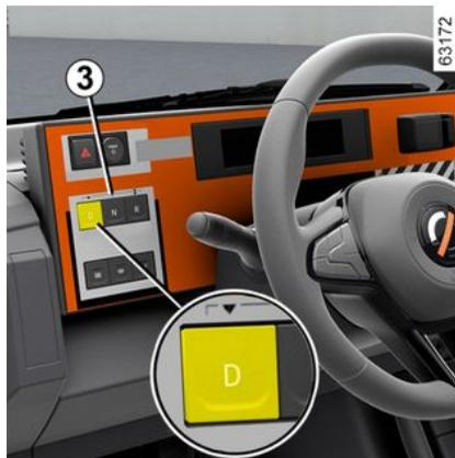
Premere il pedale del freno, quindi premere il contattore **D**. Durante la guida, premete il pedale dell'acceleratore con l'intensità necessaria fino a raggiungere la velocità desiderata.
