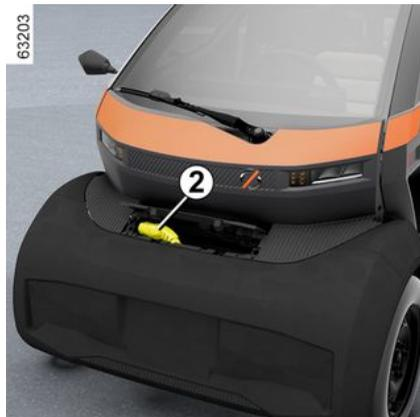
Il cavo di carica **2** può essere utilizzato per caricare completamente la batteria di trazione in circa cinque ore e 30 minuti.
