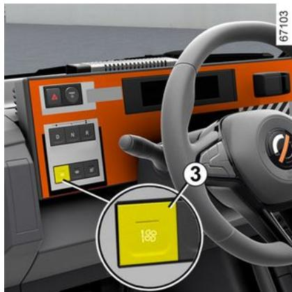
A motore acceso, premere il contattore **3** per attivare la ventilazione massima. La spia integrata al pulsante si accende.
