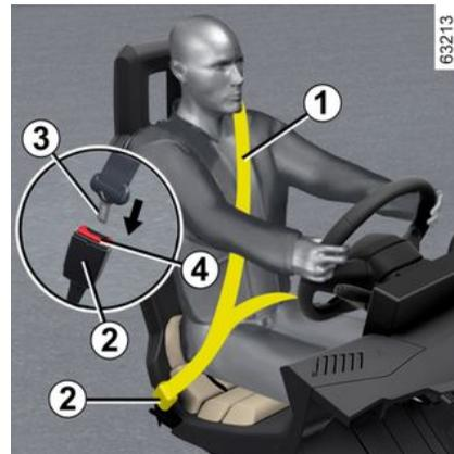
Svolgere la cintura **lentamente e senza strappi** e assicurarsi di bloccare la fibbia **3** nel modulo di bloccaggio **2** (controllare che sia ben agganciata tirando la fibbia **3**). In caso di bloccaggio, tornate indietro e svolgetela di nuovo.
