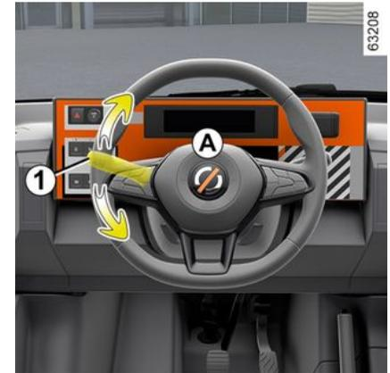
Zum Betätigen der Hupe drücken Sie die Lenkradtaste **A**.
