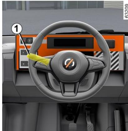
Die Abblendlichter schalten sich beim Starten des Motors ein, ohne dass der Hebel **1** betätigt wird.
