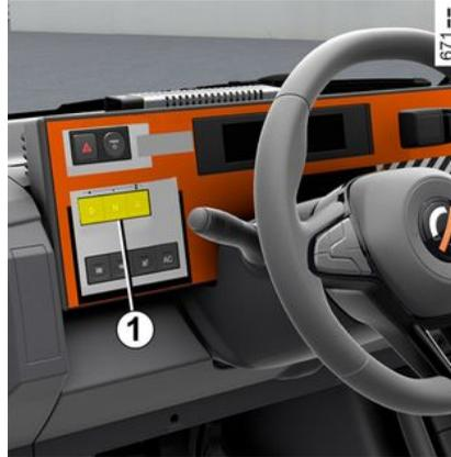
Drücken Sie einen der Schalter **1**, um eine Fahrstufe einzulegen:
