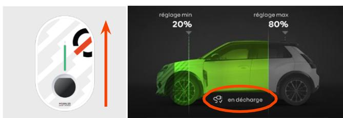
Lorsque **la lumière VERTE de la LED est montante**, l'électricité est réinjectée dans le réseau. Dans votre application, l'indication « **en décharge** » est visible.
