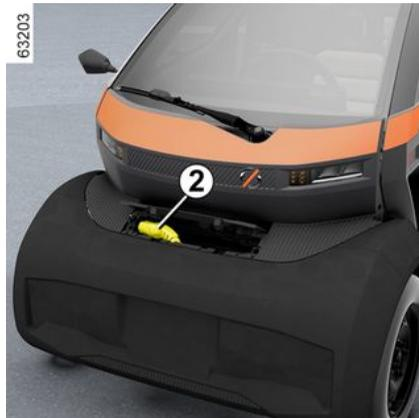
Le cordon de charge **2** permet une recharge complète de la batterie de traction en 5h30 min environ.
