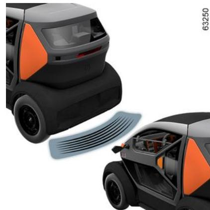
Au passage de la marche arrière, un signal sonore retentit. La plupart des objets se trouvant à moins de 1,20 mètre environ de l'arrière du véhicule sont détectés.
