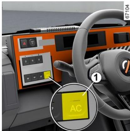
Le contacteur **1** permet la mise en service (témoin allumé) ou l'arrêt (témoin éteint) de l'air conditionné AC.
