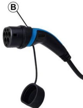
Ce cordon, spécifique à votre véhicule, pour boîtier mural spécifique ou borne publique permet la charge en usage standard de la batterie de traction.
