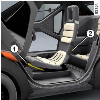
Levez la poignée **1** pour déverrouiller le siège. À la position choisie, relâchez la poignée et assurez-vous du bon verrouillage du siège.
