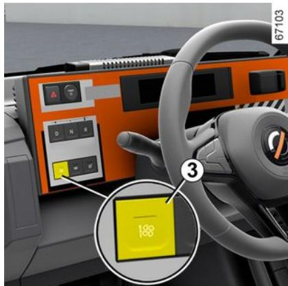
Moteur allumé, appuyez sur le contacteur **3** pour activer la ventilation maximum. Le témoin intégré au contacteur s'allume.
