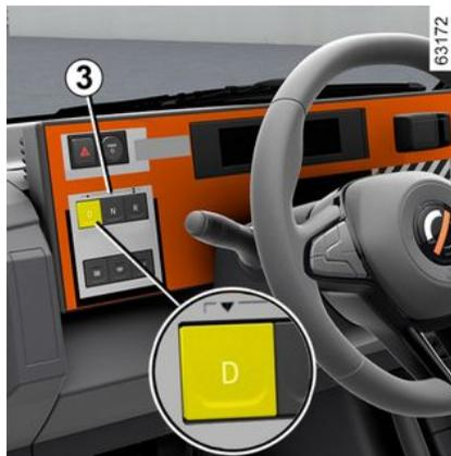
Appuyez sur la pédale de frein, puis sur le contacteur **D**. En roulage, appuyez sur la pédale d'accélérateur en fonction de la vitesse désirée.
