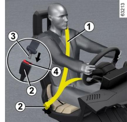
Déroulez la sangle **lentement et sans à-coups** et assurez l'encliquetage du pêne **3** dans le boîtier **2** (vérifiez le verrouillage en tirant sur le pêne **3**). En cas de blocage de la sangle, effectuez un large retour en arrière et déroulez à nouveau.
