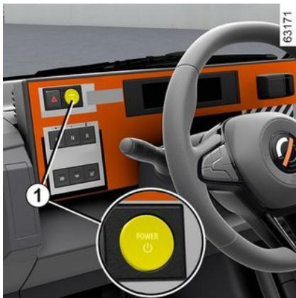
Pour déverrouiller la colonne direction, tournez légèrement le volant pendant l'appui sur le bouton de démarrage **1** du véhicule.
