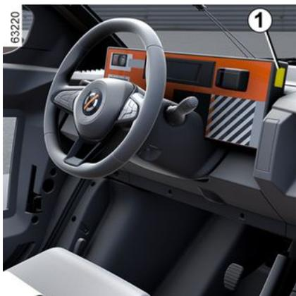
La prise USB-C **1** permet de recharger des accessoires dont la puissance ne doit pas dépasser 15 watts (tension 5 Volts).
