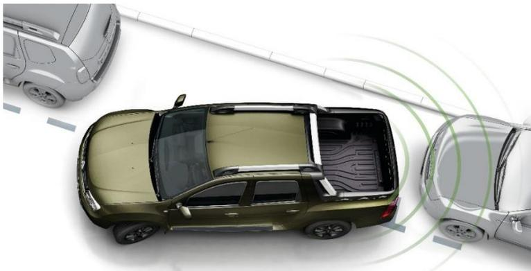
**Es un sistema capaz de detectar y avisar acústicamente** la existencia de un obstáculo dentro del área de acción. Los 4 sensores son ojos ultrasónicos que se activan al colocar la marcha atrás. La distancia del obstáculo se indica a través de la frecuencia del BEEP. Se detectan 3 zonas, si el BEEP suena continuo esta en alerta máxima. Indica distancia menor a 30 cm. Si el BEEP suena aunque el vehículo se encuentra detenido, indica zona de alerta (distancia entre 30 y 120 cm).
