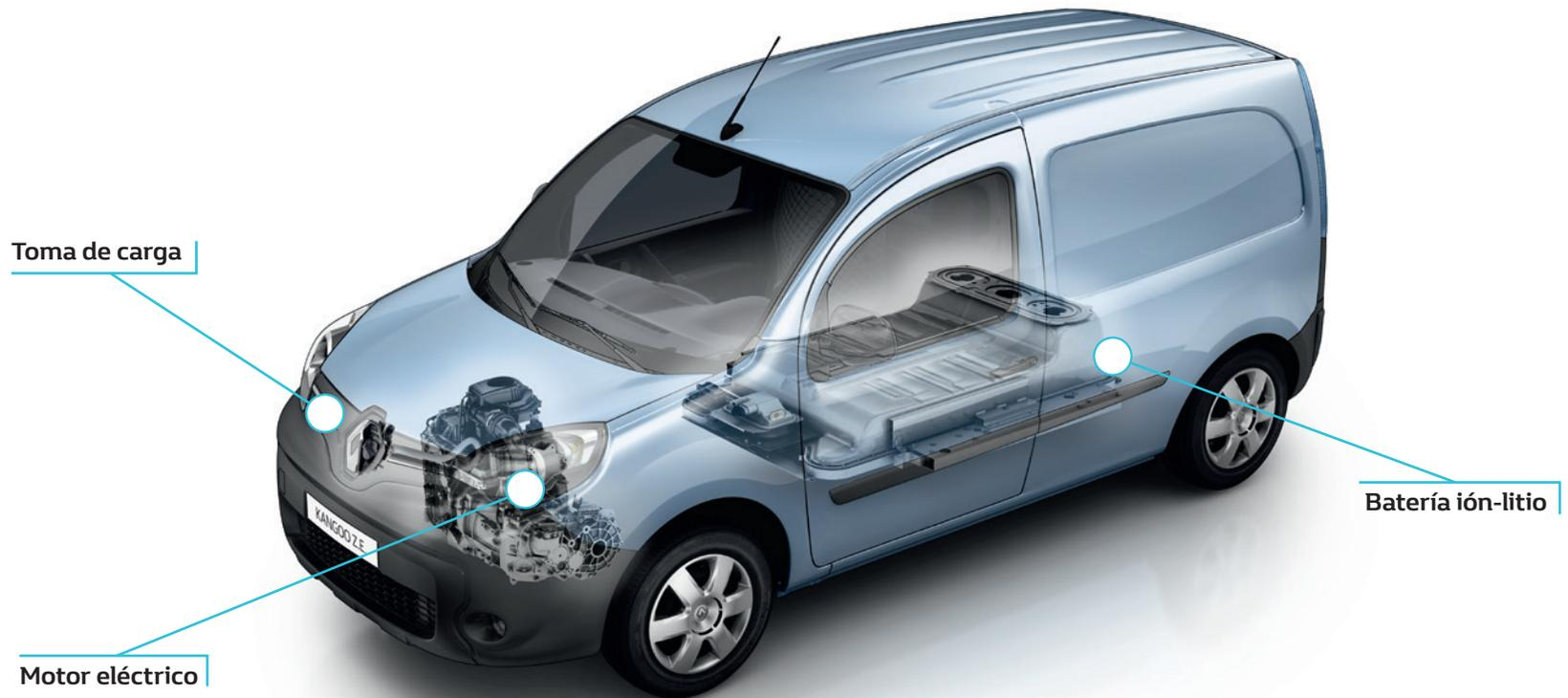
El motor 100% eléctrico del nuevo Renault Kangoo Z.E. permite aprovechar al máximo la carga de la nueva batería de ión-litio garantizando una autonomía de 270 km NEDC (ó 200 km reales). Esta autonomía varía según la velocidad, el trayecto o la climatización. El nuevo Renault Kangoo Z.E. ofrece distintas herramientas para optimizar la autonomía:
