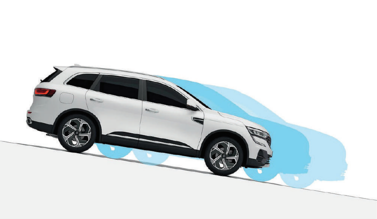
control de descenso Permite limitar la velocidad del vehículo cuando está circulando en una bajada pronunciada.
