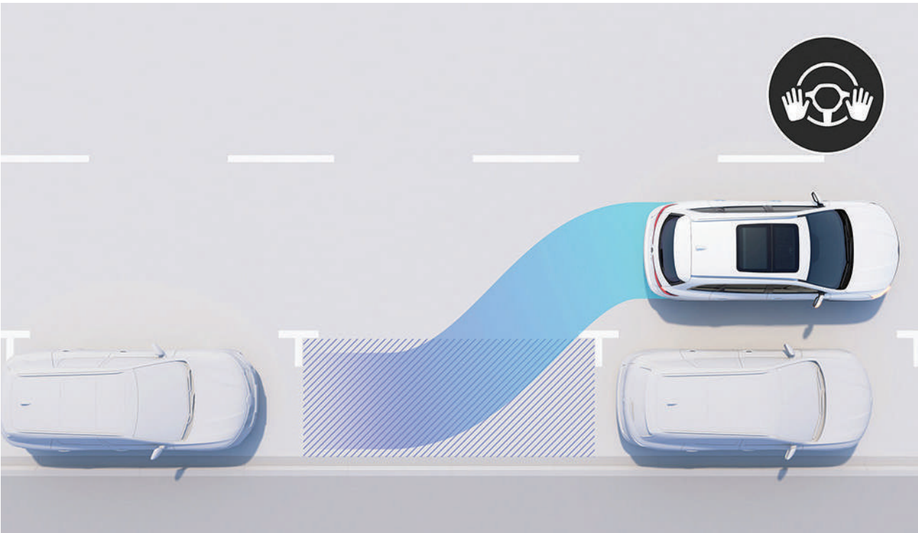
Easy Park Assist Permite estacionarse fácilmente. La búsqueda de un lugar de estacionamiento y la dirección son gestionadas por tu vehículo. Solo necesitas controlar la velocidad.
