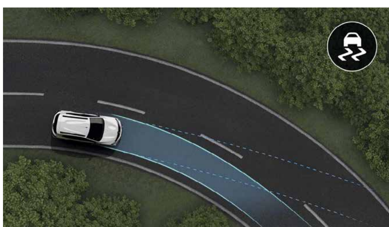
control electrónico de estabilidad (ESP) el ESP te permite corregir el curso del auto, evitando que se salga del camino, logrando que puedas manejar de forma segura en todo momento
