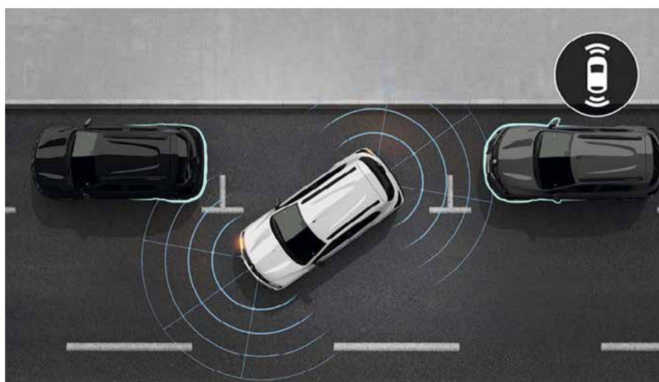
sensor de estacionamiento el sensor de estacionamiento emite una alarma auditiva cuando un objeto se encuentra cerca del vehículo, y así ofrece mayor seguridad durante las maniobras
