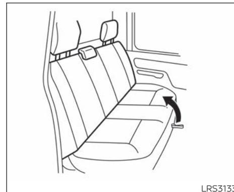
2. Presione la parte inferior del cojín del asiento hacia la parte trasera del vehículo.
