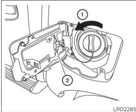
Gire el tapón de llenado de combustible ① hacia la izquierda para abrir. Coloque la tapa en el soporte de la tapa ② mientras carga combustible. El tapón de llenado de combustible es de tipo trinquete. Cuando termine de cargar combustible, gire el tapón hacia la derecha hasta que se escuchen chasquidos del trinquete.
