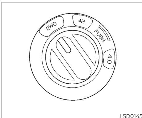
Operaciones del interruptor de cambio de 4WD (Tracción en las cuatro ruedas)
