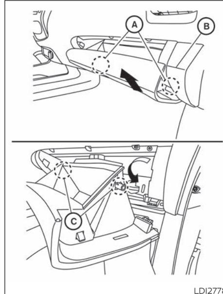
El interruptor de almacenamiento prolongado se utiliza cuando se envía el vehículo. Está situado en el panel de fusibles dentro de la guantera.
