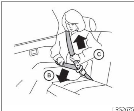
3. Coloque la parte del cinturón pélvico **baja y ajustada en las caderas (B)**, como se muestra.
