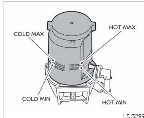
El nivel del líquido se debe revisar usando el rango HOT MAX (Máximo caliente) del depósito de aceite de la dirección hidráulica a temperaturas del aceite de 50° - 80 °C (122° - 176 °F) o utilizando el rango COLD MAX (Máximo frío) del depósito de aceite de la dirección hidráulica a temperaturas del aceite de 0° - 30 °C (32° - 86 °F).
