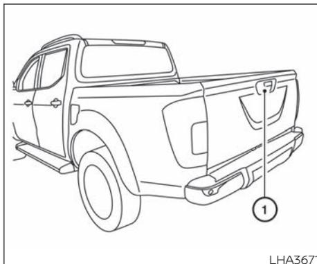
Si la cámara ① tiene suciedad, lluvia o nieve acumulada, quizás no pueda ver claramente los objetos en el monitor retrovisor. Limpie la cámara con un trapo humedecido con un agente de limpieza suave diluido, y luego limpie con un paño seco.
