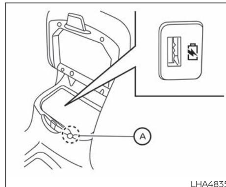
Hay un puerto de carga USB/iPod® en la caja de la consola. Este puerto cargará dispositivos compatibles.
