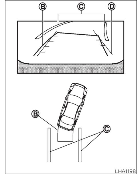
3. Mueva el vehículo lentamente en reversa, ajustando el volante de la dirección de manera que las líneas de trayecto previsto **B** ingresen al espacio de estacionamiento **C**.
