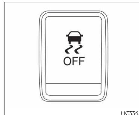
Se debe conducir el vehículo con el sistema VDC activado en la mayoría de las condiciones de conducción.
