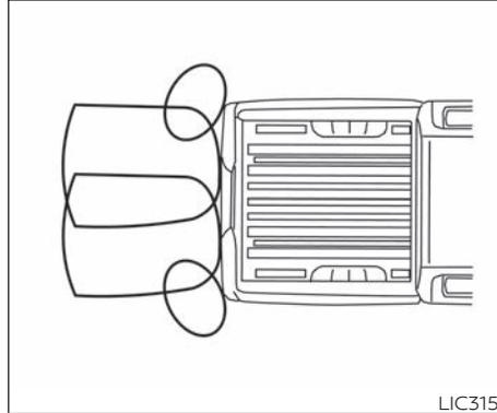
El sistema sensor de estacionamiento (sonar) emite un tono para informar al conductor que hay obstáculos cerca de la defensa.
