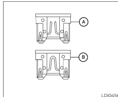
8. Si el fusible está abierto **(A)**, reemplácelo con un fusible nuevo **(B)**.
