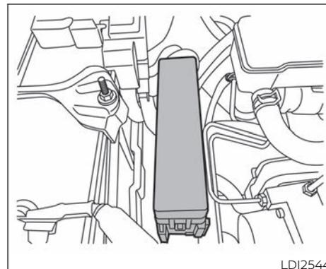
3. Quite la cubierta de la caja de fusibles empujando la lengüeta y levantando la cubierta.
