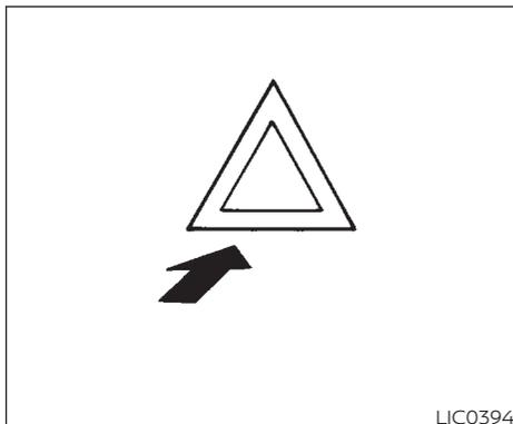
Presione el interruptor para encenderlo y así advertir a otros conductores cuando debe detenerse o estacionarse en condiciones de emergencia. Todas las luces direccionales destellan.
