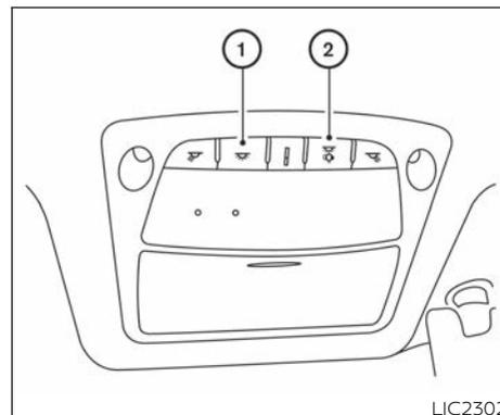
Cuando se presiona el interruptor de ENCENDIDO ①, las luces de estribo, las luces de mapa y las luces del compartimiento de pasajeros se encenderán automáticamente y permanecerán encendidas durante un período de tiempo cuando:
