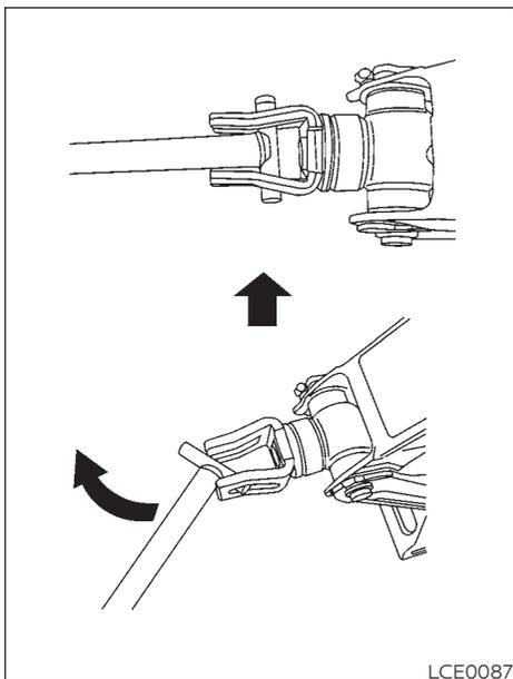
4. Para levantar el vehículo, sostenga firmemente la palanca del gato y la barra con ambas manos. Levante cuidadosamente el vehículo hasta que la llanta deje de hacer contacto con el piso.
