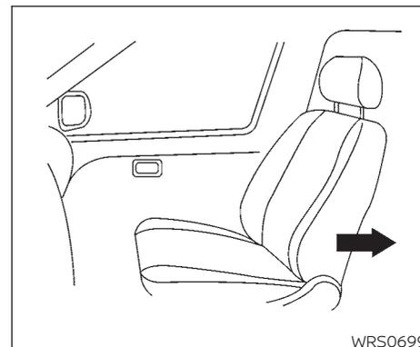
1. **Si debe instalar un asiento auxiliar en el asiento delantero, mueva el asiento completamente hacia atrás.**
