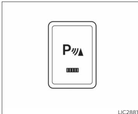
El interruptor de DESACTIVACIÓN del sistema de sensor de estacionamiento (sonar) que se encuentra en el tablero de instrumentos le permite al conductor activar y desactivar el sistema de sensor de estacionamiento (sonar). Para activar y desactivar el sistema de sensor de estacionamiento (sonar), el interruptor de encendido debe estar en la posición ON (Encendido).
