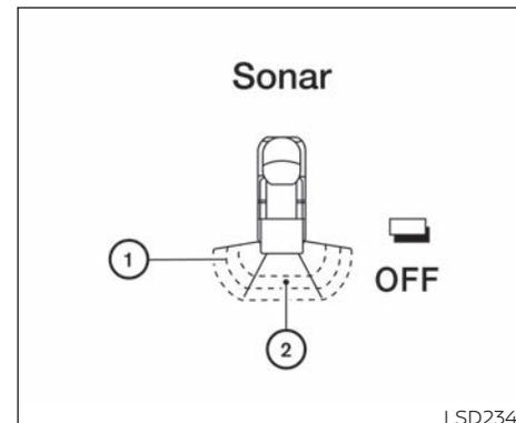
El sistema informa mediante señales visuales y audibles que hay obstáculos en la parte trasera cuando la palanca de cambios está en la posición R (Reversa).
