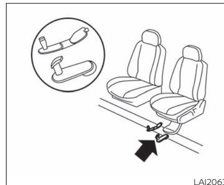
Sujetador auxiliar para la ubicación del tapete (lado del conductor solamente)
