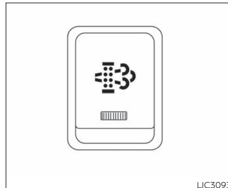
El interruptor del filtro de partículas diesel o interruptor DPF se puede utilizar para iniciar el proceso de regeneración del DPF. Este interruptor se iluminará cuando se ilumina la luz de advertencia del DPF. Esto le indica al conductor que se han acumulado partículas en el filtro y que no se pueden quemar automáticamente. Para obtener información adicional, consulte "Luz de advertencia del filtro de partículas diesel (DPF)" en esta sección.
