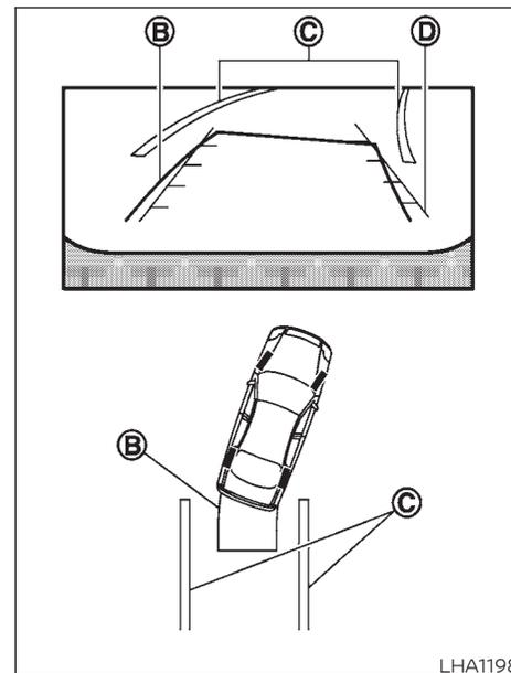
3. Mueva el vehículo lentamente en reversa, ajustando el volante de la dirección de manera que las líneas de trayecto previsto **B** ingresen al espacio de estacionamiento **C**.
