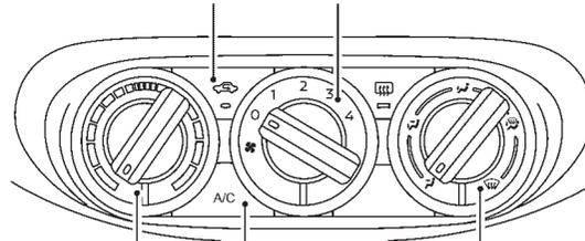
Selector de control de temperatura    Botón A/C (A/A)    Selector de control del flujo de aire
