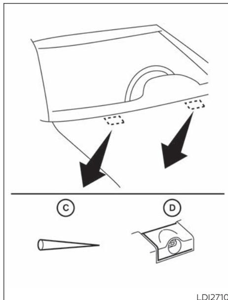
Tenga cuidado de no permitir el ingreso de ningún elemento a la boquilla del lavador (D). Esto puede provocar obstrucciones o un funcionamiento incorrecto del lavaparabrisas. Si ingresa algo en la boquilla, quítelo con una aguja o con un alfiler pequeño (C).
