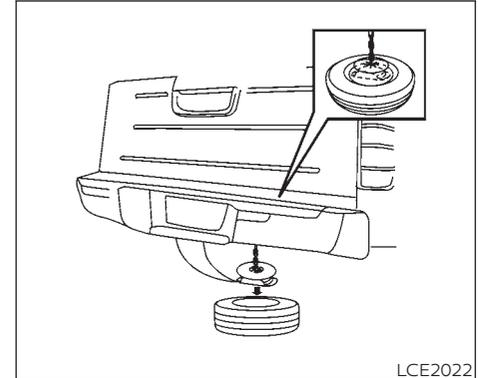
7. Para reinstalar la rueda, inserte la cadena para llantas a través de la rueda. Asegúrese de que el espaciador de hule esté centrado en la rueda antes de levantarla. Utilice la barra del gato ensamblada y lentamente gire el malacate hacia la derecha para levantar la rueda al vehículo.
