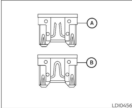
5. Si el fusible está abierto (A), reemplácelo con un fusible nuevo (B).
