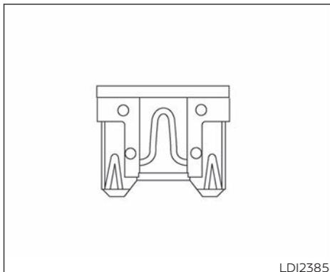
Si los equipos eléctricos no funcionan, revise si hay un fusible abierto.
