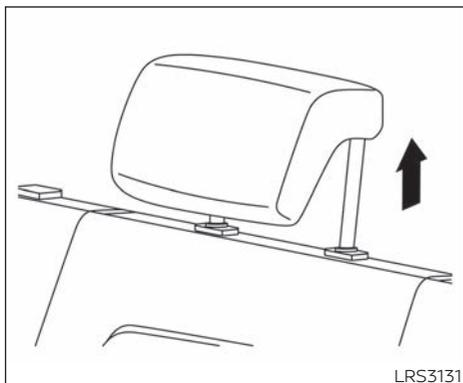
La cabecera trasera central sólo se debe utilizar en la posición de vástago con muesca. La posición más baja es la posición de almacenamiento.
