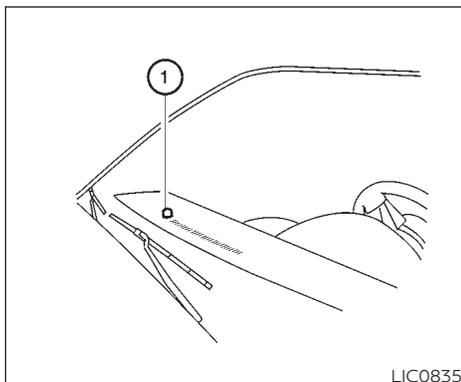
**Asegúrese de no poner nada encima del sensor de las luces automáticas que se encuentra en la parte superior ① del tablero de instrumentos. El sensor de autoiluminación controla la autoiluminación; si lo cubre, el sensor de autoiluminación reaccionará como si hubiera oscurecido afuera y los faros se encenderán. Si esto ocurre con el vehículo estacionado, el motor apagado y el interruptor de encendido en la posición ON (Encendido), la batería del vehículo podría descargarse.**
