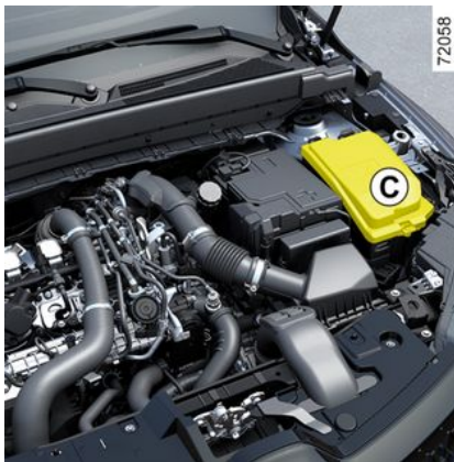
Fusibles en el compartimento del motor C
