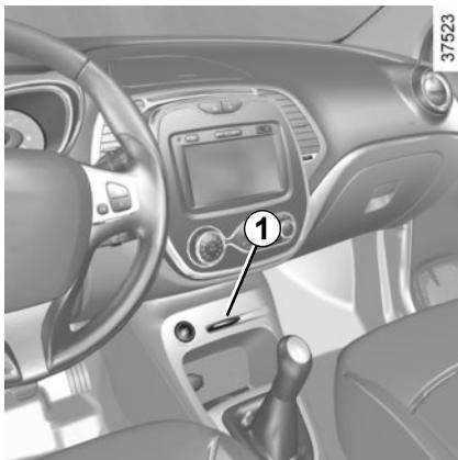
Antes de realizar cualquier remolcado, ponga la palanca en punto muerto (posición **N** para los vehículos equipados con una caja de velocidades automática).
