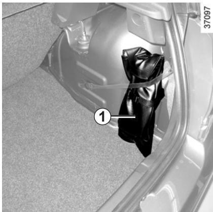
El bloque de herramientas **1** está situado en el lateral del maletero. Incluye un conjunto de herramientas útiles para diferentes intervenciones en el vehículo: crique, llave de rueda y llave para extracción de embellecedores.
