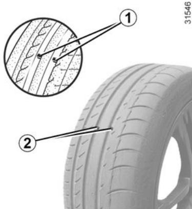
Los neumáticos deben estar en buen estado y sus dibujos deben presentar una profundidad suficiente ; los neumáticos homologados por nuestros servicios técnicos van provistos de testigos de desgaste **1** compuestos por **indicadores en varios puntos de la banda de rodadura.**
