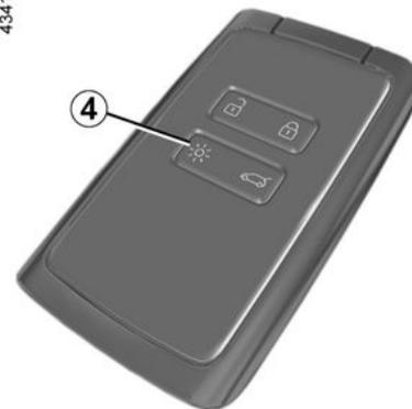
Una presión en el botón **4** enciende la iluminación interior, las luces de posición y las luces de cruce durante 20 segundos, aproximadamente. Esto permite, por ejemplo, localizar de lejos el vehículo estacionado en un parking.
