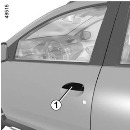
Con las puertas desbloqueadas ➔ **33**, coloque la mano debajo de la empuñadura **1** y tire hacia usted.
