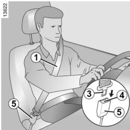
Desenrolle la cinta **lentamente y sin tirones** y asegúrese de que queda encajado el gancho **3** en la caja **5** (compruebe que ha quedado bien abrochado tirando del gancho **3**). Si la cinta se traba, déjela retroceder y desenrolle de nuevo lentamente. Si su cinturón se queda completamente bloqueado, tire lentamente, pero con fuerza de la cinta
