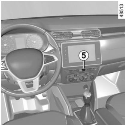
Según el vehículo, permite bloquear o desbloquear de forma simultánea las cuatro puertas y el maletero. Bloquee o desbloquee las puertas pulsando el contactor **5**.
