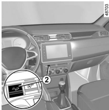
Este dispositivo permite limitar la velocidad del vehículo sin tener que pisar el pedal de freno (cuando esté circulando en una bajada pronunciada).
