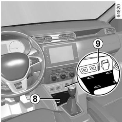
Según el vehículo, es posible utilizar la zona **8** para cargar su teléfono sin conectarlo a un cable de carga.
