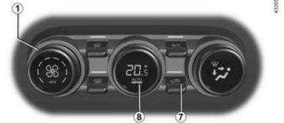
Esta función se gestiona automáticamente, pero puede activarla manualmente. En tal caso, el testigo situado encima del botón **7** confirma la operación.
