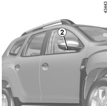
Las cámaras **2**, instaladas en los retrovisores exteriores, generan las vistas laterales en la pantalla **4**.
