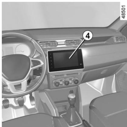
El modo automático se activa cuando se selecciona la marcha atrás y la pantalla **4** muestra la vista desde la cámara de marcha atrás. Cuando se produce un cambio rápido de la marcha atrás a una marcha adelante, la pantalla **4** muestra la imagen de la cámara delantera.
