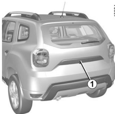
Al meter la marcha atrás, la cámara **1** situada en el portón transmite una vista del entorno trasero del vehículo en la pantalla multimedia **2**, acompañada de líneas auxiliares fijas.
