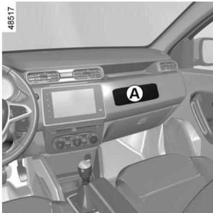
Una identificación "airbag" en el volante, en el salpicadero (en la zona del airbag **A**) y, según el vehículo, en una etiqueta en la parte inferior del parabrisas le recuerdan la presencia de este equipamiento.
