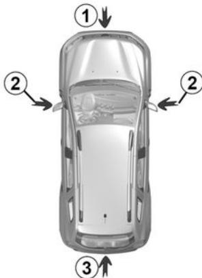
Si están equipadas en el vehículo, las cuatro cámaras **1**, **2** y **3** situadas en el parachoques delantero, los retrovisores exteriores y la puerta del maletero le ayudarán con las maniobras difíciles.
