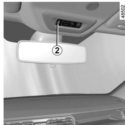
Con el contacto puesto, **compruebe imperativamente** que el testigo
