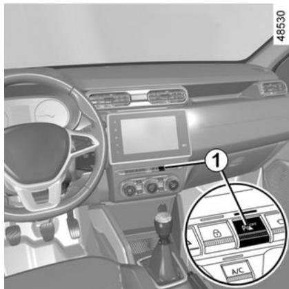
Puede desactivar el sistema mediante una presión prolongada en el contactor **1**.
