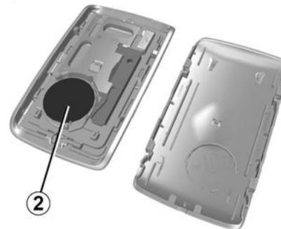
Para el montaje, proceda en sentido inverso y pulse cuatro veces, estando cerca del vehículo, uno de los botones de la tarjeta : la próxima vez que arranque, el mensaje ya no aparecerá.
