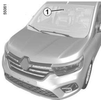
Utilizando la información de la cámara **1**, la función activa una corrección en el sistema de dirección del vehículo cuando se cruza una línea continua o discontinua, o al acercarse a borde de la carretera (mediana, barrera, talud, terraplén, etc.) sin que se activen las luces indicadoras de dirección (intermitentes).
