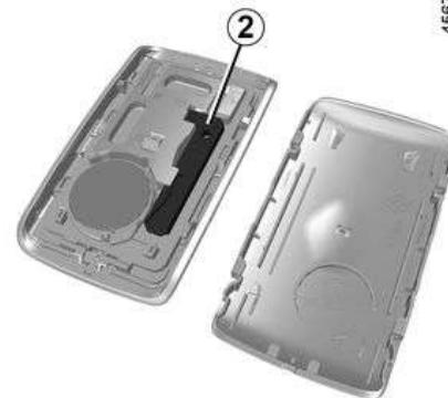
La llave integrada **2** se puede utilizar para bloquear o desbloquear la puerta del conductor cuando la tarjeta no funciona.
