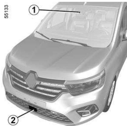
El sistema utiliza información procedente de la cámara **1** y del radar **2**, para determinar la distancia entre el vehículo:
