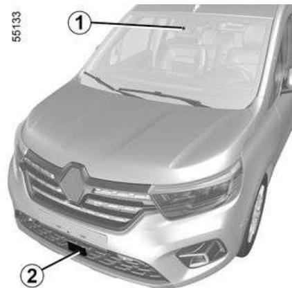
El sistema utiliza información procedente del radar **2** y de la cámara **1** para determinar la distancia que separa a su vehículo:
