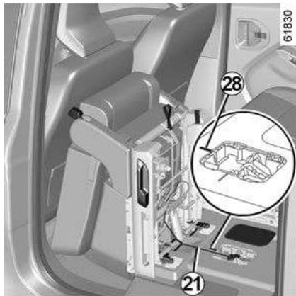
**i** Al volver a colocar un asiento en el vehículo, asegúrese de volver a conectar el conector del asiento. En caso contrario, la información sobre la hebilla del cinturón de seguridad no se visualiza en el cuadro de instrumentos ➔ **85**.
