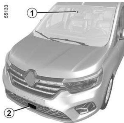
Gracias a la información del radar **2** y la cámara **1**, esta función advierte al conductor del intervalo de tiempo que le separa del vehículo que le precede, para respetar la distancia de seguridad entre ambos.
