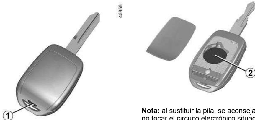
Abra la caja por la hendidura **1** con un destornillador plano o una herramienta similar y sustituya la pila **2** respetando el modelo y la polaridad que se muestran en el fondo de la tapa.
