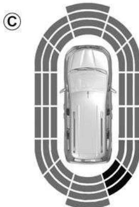
El sistema es capaz de detectar la mayoría de los obstáculos ubicados cerca de la parte trasera y, en función del equipamiento, cerca de la parte delantera y los laterales del vehículo.
