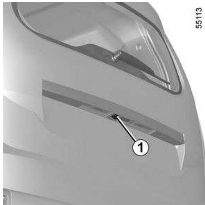
Según el vehículo, cuando se engrana la marcha atrás, la cámara **1** situada en el portón trasero o en la puerta trasera abatible transmite una vista del entorno situado detrás del vehículo a:
