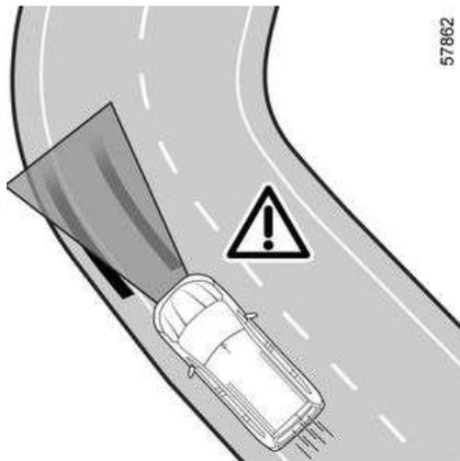
Si hay una curva cerrada, según la velocidad del vehículo, las capacidades de retención lateral de la función serán limitadas y requerirán que el conductor actúe de inmediato
