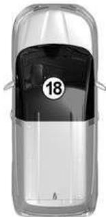
Después de abrir y cerrar una puerta **con el motor en marcha**, si la tarjeta ya no está en la zona **18**, el mensaje "Tarjeta no detectada" advierte de que la tarjeta no se encuentra en el vehículo. Esto permite evitar, por ejemplo, reanudar la marcha si un pasajero sale del vehículo llevándose la tarjeta.
