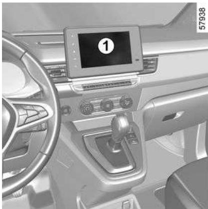
Con el vehículo parado y el motor en marcha, desde el menú "Ajustes" de la pantalla multimedia **1**, seleccione la pestaña "Vehículo" y, a continuación, utilice el menú "Programación" para configurar la carga de su vehículo.
