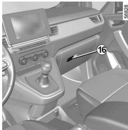
Si el vehículo está equipado, tire de la empuñadura **16** para abrirlo.
