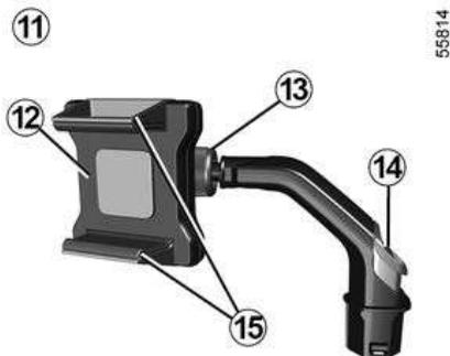
En los vehículos equipados, abrir el compartimento guardaobjetos **A** e insertar el soporte del teléfono en uno de los emplazamientos **16** mientras se presiona el botón **14**.
