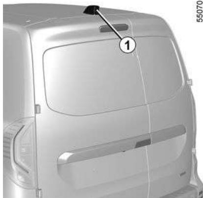
Al poner el contacto, la pantalla **2** situada sobre la consola central del techo muestra la vista de detrás del vehículo que transmite la cámara **1**.
