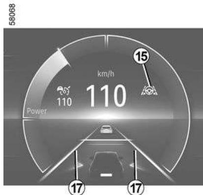
Si el conductor no interviene, la función activa la vibración del volante para advertir de que el vehículo está a punto de traspasar una línea y de que el conductor debe actuar de inmediato.
