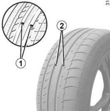
Cuando la banda de rodadura de los neumáticos se gaste hasta llegar al nivel de los indicadores de desgaste, **estos se hacen visibles 2**: es **necesario** sustituirlos porque la goma tiene **una profundidad máxima de 1,6 mm, lo que perjudica la adherencia en carreteras mojadas**.
