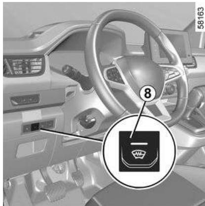
**Con el motor en marcha**, presionar el interruptor **8** (el testigo integrado se enciende).
