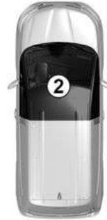
La tarjeta debe estar en la zona de detección **1** o, según el vehículo, en la zona de detección **2**.
