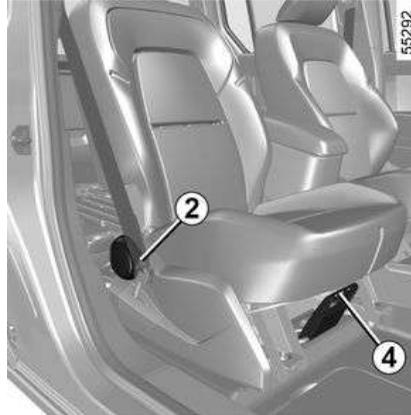
Según el asiento, levante la palanca **2** y bascule el respaldo hasta la posición necesaria.
