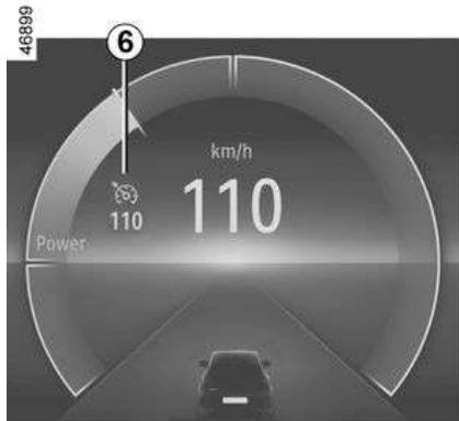
El testigo de advertencia **6** desaparece del cuadro de instrumentos para confirmar que se ha detenido la función.
