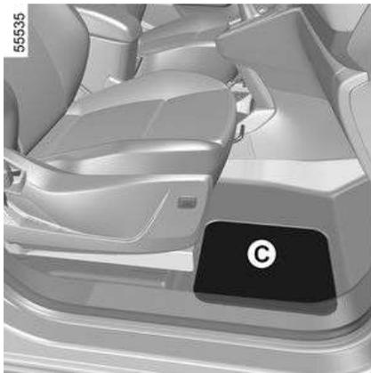
Según el vehículo, en caso de pinchazo, utilizar el kit situado en el compartimento guardaobjetos localizado bajo la trampilla **C**, en el espacio para los pies del asiento delantero derecho.
