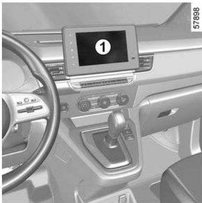
Con el motor en marcha y el vehículo detenido, desde la pantalla multimedia **1** seleccionar el menú "Ajustes", la pestaña "Vehículo", el menú "Programación" **2** y, finalmente, la pestaña "Confort" **4**.
