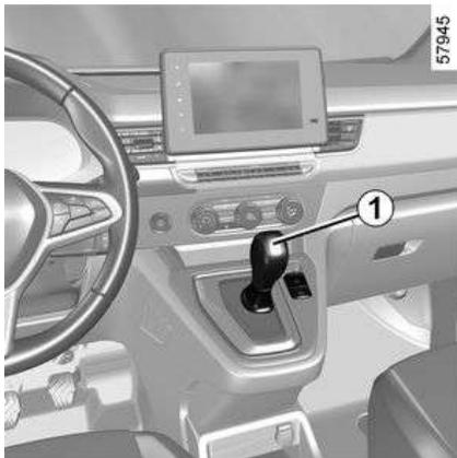
Con la palanca de cambios **1** en la posición **P**, arranque el motor y el mensaje "READY" se mostrará en el cuadro de instrumentos.
