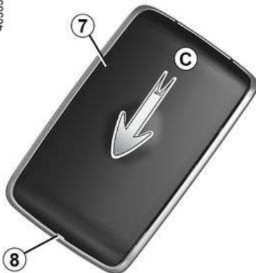
Deslizar la carcasa trasera **7** hacia abajo mientras se presiona la zona **C**.
