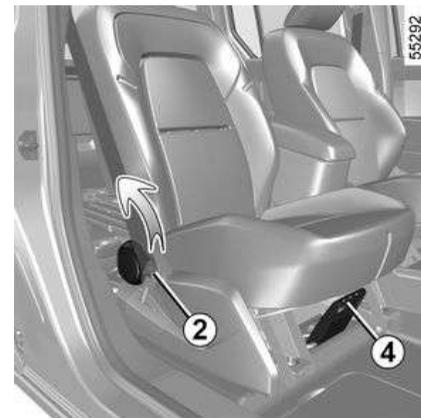
Según el vehículo, el respaldo del lado del pasajero puede abatirse sobre el asiento y permite obtener una posición de suelo plano.
