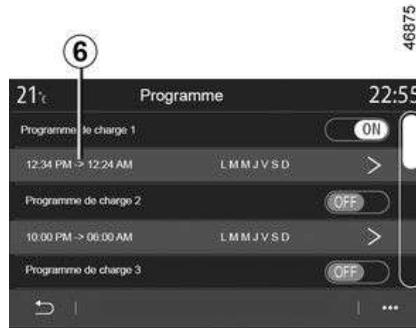
Ajuste las horas de inicio y de fin de carga, así como los días a los que se aplicarán estas horas. Pulse "Guardar" para confirmar.
