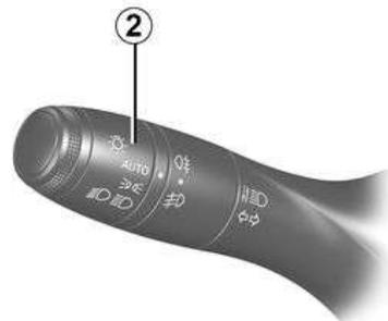
Las luces se apagarán automáticamente al parar el motor, al abrir la puerta del conductor o al bloquear el vehículo. En este caso, la
