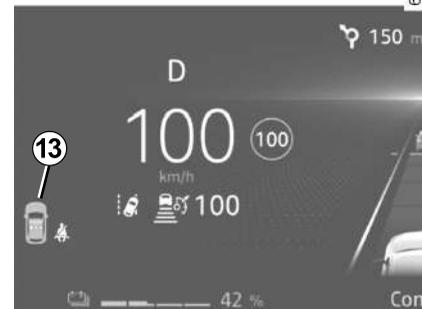
El gráfico **12** o, según el vehículo, **13** se muestra en el cuadro de instrumentos al poner el contacto del vehículo. De este modo se informa al conductor del estado de cada uno de los cinturones de seguridad traseros cada vez:
