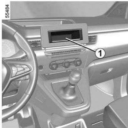
Suelte la cubierta. Las conexiones: antena, alimentación (+ y -) y cableado de los altavoces se encuentran detrás.
