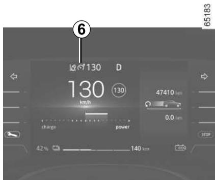
Para guardar la velocidad actual, pulse los interruptores **4** (RES/+) o **3** (SET/-): la velocidad limitada reemplaza los guiones y, según el vehículo, el testigo **6** aparece en blanco.
