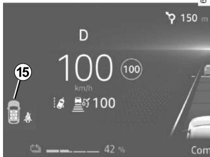
Con las puertas cerradas, el gráfico **14** o, según el vehículo, **15** aparece en el panel de instrumentos durante aproximadamente 60 segundos cuando se conecta el encendido del vehículo. De este modo se informa al conductor del estado de cada uno de los cinturones de seguridad traseros cada vez:
