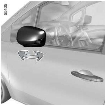
Para plegar el retrovisor exterior, tire de él hacia el cristal de la puerta hasta que encaje de forma mecánica.
