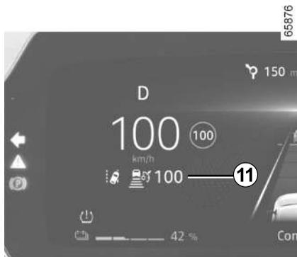
Se puede exceder la velocidad de regulación en cualquier momento pisando el pedal del acelerador.
