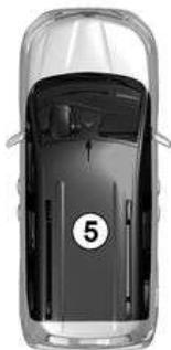
Después de abrir y cerrar una puerta **con el motor en marcha**, si la tarjeta no está en la zona **5**, el mensaje "Tarjeta no detectada" advierte de que la tarjeta no se encuentra en el vehículo. Esto permite evitar, por ejemplo, reanudar la marcha si un pasajero sale del vehículo llevándose la tarjeta.
