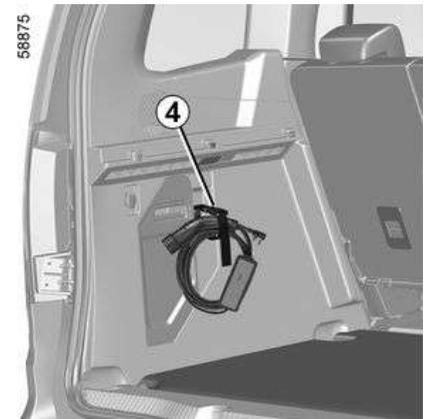
Utilizar la correa **4** para sujetar y guardar el cable una vez enrollado.
