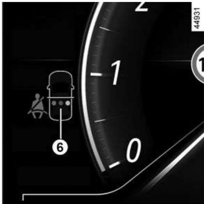
Cuando la velocidad del vehículo alcanza o supera el valor de 20 km/h, si uno de los cinturones de seguridad traseros se desabrocha durante el trayecto:
