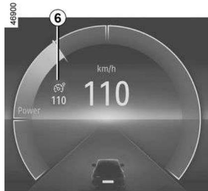
Pulse el interruptor 1. Se muestra el testigo 6 en color gris. Se muestra el mensaje "Limitador ON" en el cuadro de instrumentos junto con guiones para indicar que la función limitador de velocidad está activada y a la espera de almacenar la velocidad de regulación.
