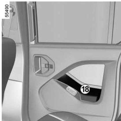
Los objetos colocados en los compartimentos de las puertas laterales deslizantes no deben sobresalir de estos para no obstaculizar el deslizamiento de la puerta.
