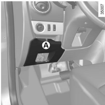
Si un aparato eléctrico no funciona, verifique el estado de los fusibles. Suelte la tapa **A**.
