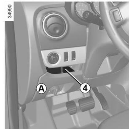
Pase la mano por el emplazamiento **4** y tire para abrir el guardaobjetos **A**.
