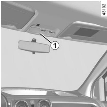
Suelte el difusor **1** utilizando, por ejemplo, un destornillador plano.
