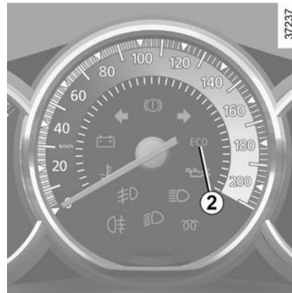
El modo ECO es una función que optimiza el consumo de combustible. Actúa en algunos sistemas consumidores de energía en el vehículo (calefacción, climatización, dirección asistida, etc.) y en determinadas acciones de conducción (aceleración, cambio de velocidades, regulador de velocidad, desaceleración, etc.).
