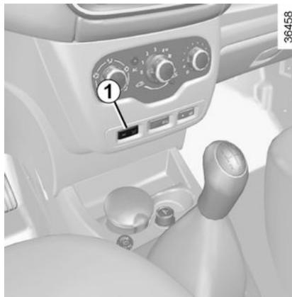
La función regulador de velocidad queda interrumpida cuando usted actúa en el contactor **1**, en este caso la velocidad no queda memorizada. El apagado de los testigos verdes
