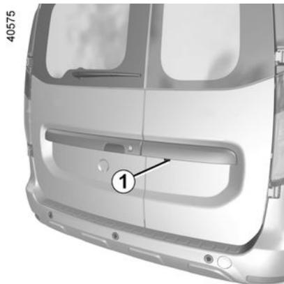
Al meter la marcha atrás, la cámara **1** transmite una vista del entorno trasero del vehículo a la pantalla multimedia **2**, acompañada de líneas auxiliares fijas.
