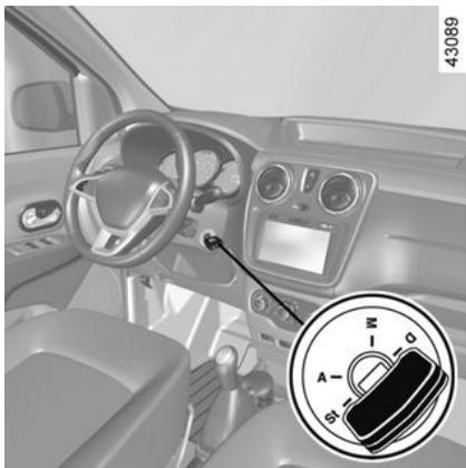
Para bloquearla, retire la llave y gire el volante hasta obtener el bloqueo de la dirección.
