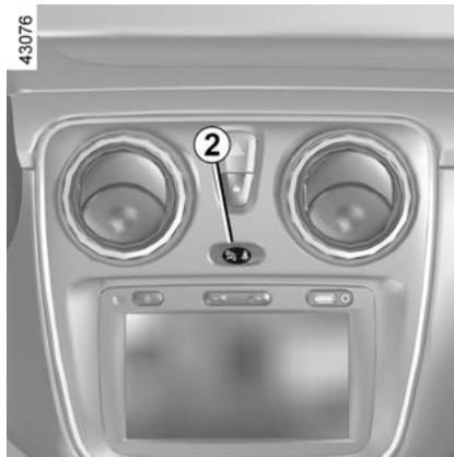
Para desactivar el airbag del pasajero, con el vehículo parado y sin el contacto puesto, presione y gire el botón 2 hasta la posición OFF.
