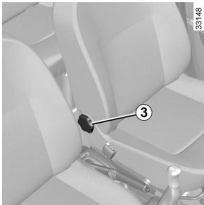
Gire el comando **3** e incline el respaldo hasta la posición deseada.
