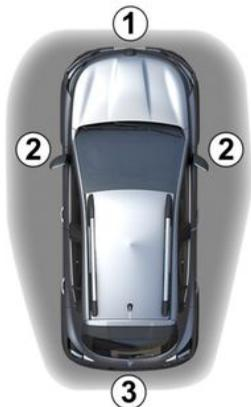
Si se instalan en el vehículo, las cuatro cámaras **1**, **2** y **3** en el parachoques delantero, en los retrovisores exteriores y en la puerta del maletero ayudan en las maniobras difíciles.
