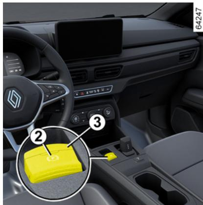
Se puede activar manualmente el freno de aparcamiento asistido.
