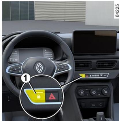
Cuando el vehículo inicia su marcha, el sistema bloquea automáticamente las puertas una vez alcanzada la velocidad aproximada de 10 km/h.
