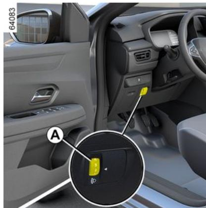
Se puede usar el mando **A** para ajustar la altura de los faros de carretera según la carga del vehículo.
