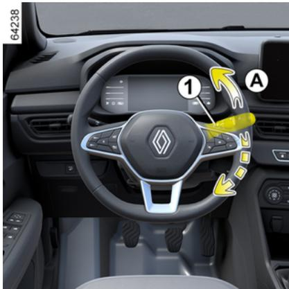
Para volver a colocar los limpiaparabrisas, colóquelos primero en la posición de reparación **B**.
