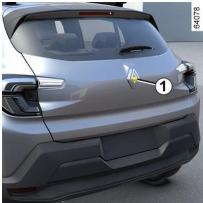
Cuando se introduce la marcha atrás, la cámara **1** muestra una vista del entorno trasero del vehículo en la pantalla multimedia **2**, acompañada de una o dos líneas auxiliares **3** y **4**.
