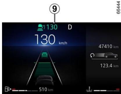
En cualquier momento, se puede superar la velocidad regulada pisando el pedal del acelerador.
