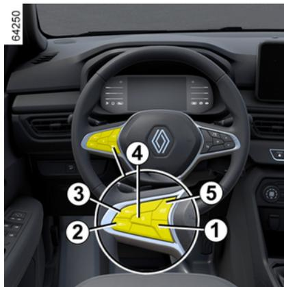
Puede usted hacer variar la velocidad de regulación actuando por presiones sucesivas en:
