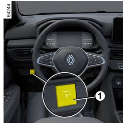
Pulse el interruptor **1** para desactivar la función. El testigo situado encima del contactor **1** se enciende.
