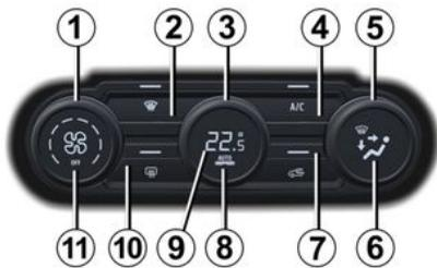
1. Reglaje de la velocidad de ventilación
