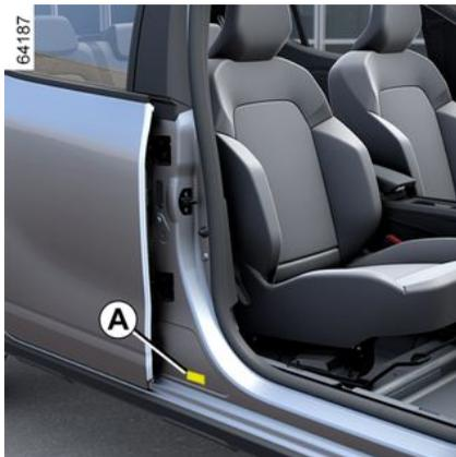
La presencia de la placa de identificación **A** depende del vehículo.
