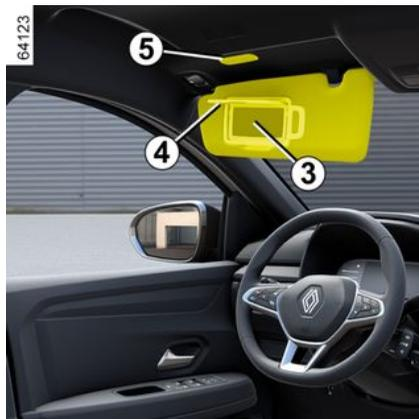
Los parasoles están equipados con un espejo de cortesía. Levantar la tapa **4**. Según el vehículo, la luz **5** se encenderá automáticamente.
