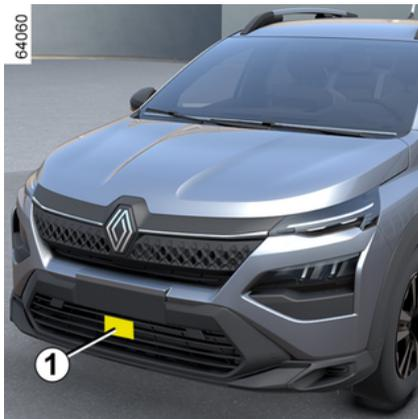
Mediante la información del sensor **1**, la función informa al conductor del intervalo de tiempo entre el vehículo y el de delante con el fin de mantener una distancia de frenado segura entre ambos.
