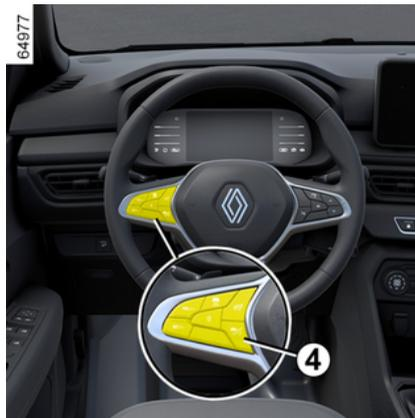
La función del regulador de velocidad adaptativo automático se desactiva al presionar el interruptor 4.
