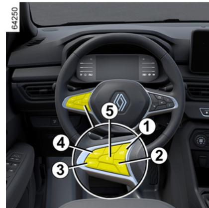
La velocidad límite puede modificarse presionando repetidamente o manteniendo presionado:
