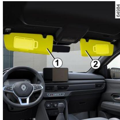
Baje el parasol **1** o **2** en el parabrisas o suéltelo y gírelo en el cristal lateral.
