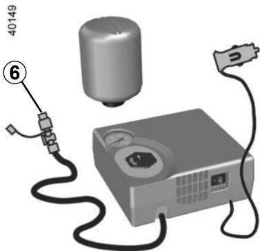
Una vez que el neumático se ha inflado correctamente, retire el kit: desenrosque lentamente la boca de inflado **6** para evitar la proyección de producto y almacene la botella en un envase de plástico para evitar la caída del producto.
