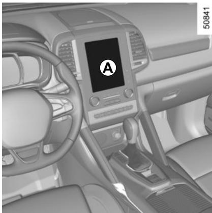
Con el aire acondicionado en funcionamiento, en la pantalla **A**, seleccione «Menú», «Vehículo», «Precaución».
