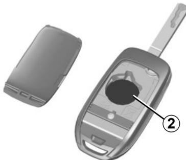
**Nota:** al sustituir la pila, tenga cuidado de no tocar el circuito electrónico situado en la tapa de la llave.
