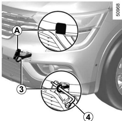
Utilice exclusivamente el punto de remolcado delantero **A** y el punto de remolcado trasero **5** (nunca utilice los tubos de transmisión).
