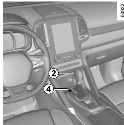
**Al poner el vehículo en marcha**, si la palanca se queda bloqueada en **P** al pisar el pedal de freno, existe la posibilidad de liberarla manualmente. Para ello, suelte la trampilla **4**, pase una herramienta (varilla rígida) por el orificio **2** y pulse simultáneamente el botón para desbloquear la palanca.
