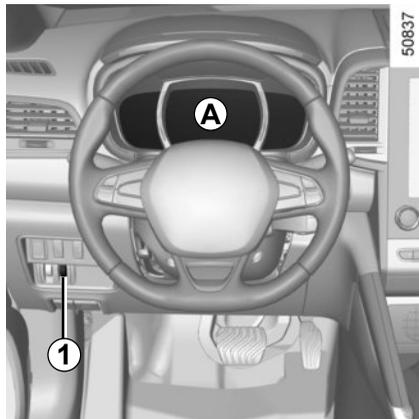
**Cuadro de instrumentos A:** se ilumina cuando se abre la puerta del conductor. Con el contacto puesto, gire la rueda **1** para ajustar la luminosidad del cuadro de instrumentos.
