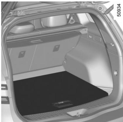
La presencia de las herramientas depende del vehículo. Los útiles se encuentran en el cajón, bajo la moqueta del maletero. Levante la moqueta y sáquelo.
