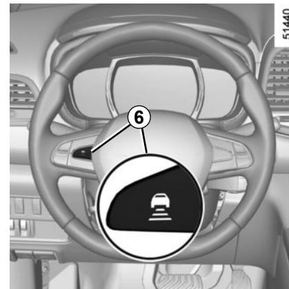
La velocidad de regulación sustituye a los guiones y se confirma la función de regulación con la iluminación en verde de la velocidad de regulación y del mensaje «ACC Regulador» además del testigo .
