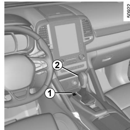
Al poner el vehículo en marcha, si la palanca se queda bloqueada en **P** al pisar el pedal de freno, existe la posibilidad de liberarla manualmente. Para ello, suelte la trampilla **1**, pase una herramienta (varilla rígida) por el orificio **2** y pulse simultáneamente el botón para desbloquear la palanca.
