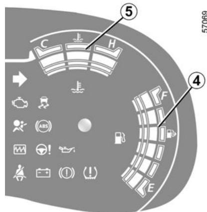
Indicador de temperatura del motor 5
