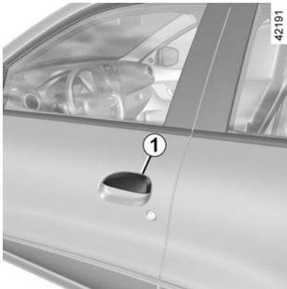
**Con las puertas desbloqueadas** (consulte la información sobre bloqueo y desbloqueo de las puertas → 25), coloque la mano en la empuñadura 1 y tire hacia usted.
