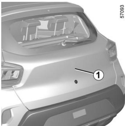
Dependiendo del vehículo, al dar marcha atrás (y hasta unos cinco segundos después de cambiar de marcha), la cámara **1** transmite una imagen de la zona alrededor de la parte trasera del vehículo, acompañada de una línea de guía fija, a la pantalla táctil **2**.
