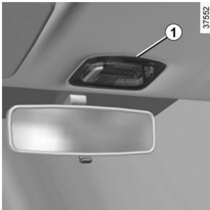
Suelte la luz de cortesía **1** utilizando un destornillador plano o una herramienta similar.
