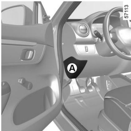
Si un aparato eléctrico no funciona, verifique el estado de los fusibles. Tire de la tapa **A** desde el borde inferior para sacarla y poder acceder a los fusibles.
