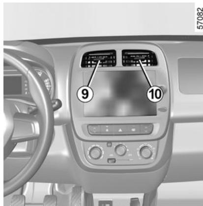
Para ajustar el flujo de aire, mueva la lengüeta **9** o **10** hacia arriba, abajo o hacia el lado.
