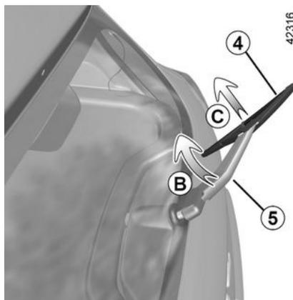
Con el limpiaparabrisas en la posición de parada y el contacto cortado, levante el brazo del limpiaparabrisas **5**. Gire la hoja **4** hasta que encuentre algo de resistencia (movimiento **B**). Suelte la escobilla (movimiento **C**) tirando de ella.
