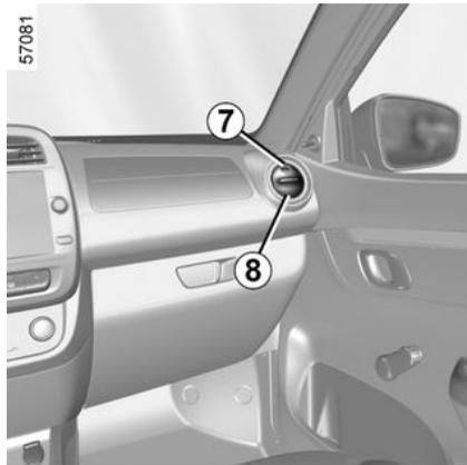
Para abrir, presione la salida de aire (punto **7**) hasta que esté suficientemente abierta.
