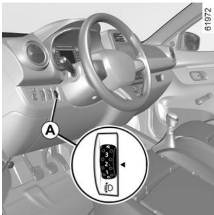
Se puede usar el mando **A** para ajustar la altura de los faros según la carga del vehículo.
