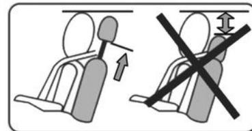
Introduzca las varillas en los forros del asiento trasero, con la muesca en posición 1 y baje el reposacabezas hasta la posición deseada. Asegúrese de que ha quedado bloqueado en su lugar.
