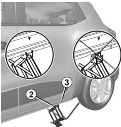
Coloque el gato **2** debajo de la carrocería del vehículo, **alineándolo con la marca de punto de elevación 3** más cercana a la rueda que se va a sustituir.
