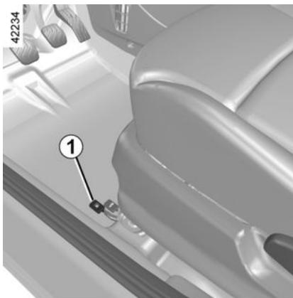
Para abrir la tapa del depósito de carburante **A**, tire del control **1**.
