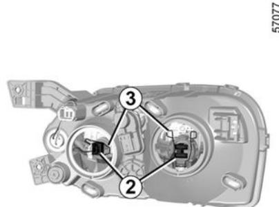
Una vez cambiada la lámpara, vuelva a poner la tapa correctamente.
