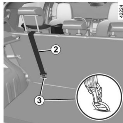
Pase el cinturón **2** entre el respaldo y la bandeja trasera. Para ello, primero tiene que enrollar el cubreequipajes. Fije el gancho en una de las anillas **3** que se indican con el símbolo:
