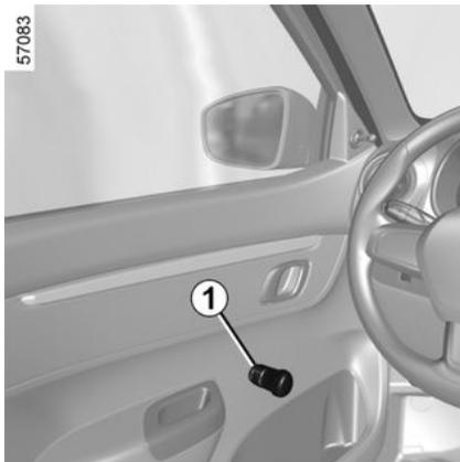
En función del vehículo, gire la manivela **1** para bajar o subir el cristal hasta la altura deseada.
