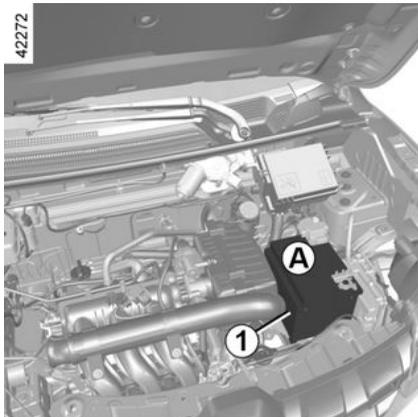
La batería **1** no necesita mantenimiento. **No lo abra ni añada líquidos de ningún tipo.**
