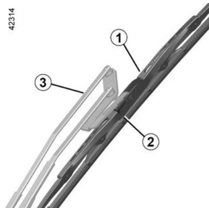
Con el limpiaparabrisas en la posición de parada y el contacto cortado, levante el brazo del limpiaparabrisas **3**, presione la lengüeta **2** y empuje la escobilla hacia abajo para liberar el conjunto.
