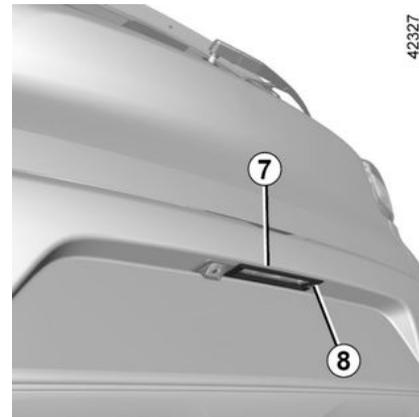
Separe la lámpara 7 presionando la lengüeta 8 con un destornillador, por ejemplo.
