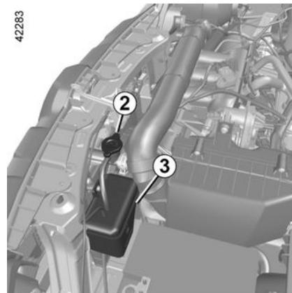
Con el contacto apagado y sobre terreno horizontal, el nivel **en frío** debe estar situado entre las marcas "MIN" y "MAX" indicadas en el depósito **3**.
