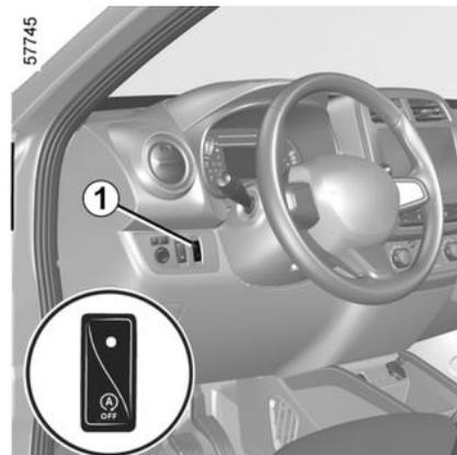
El sistema se activará automáticamente cada vez que se arranque el vehículo con la llave (➔ 84).
