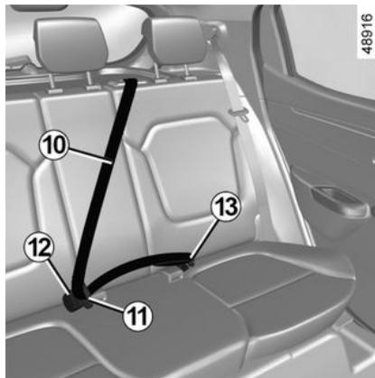
Desenrolle lentamente el cinturón de seguridad **10** e inserte la hebilla **11** en el cajetín de bloqueo **12**.
