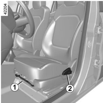
Levante la barra **1** para desbloquearlo. Deslice el asiento hasta la posición deseada, suelte la barra **1** y asegúrese de que queda bien bloqueada.
