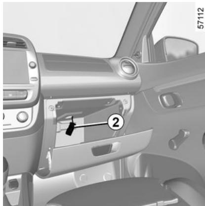
Separe la lámpara **2** con un destornillador o una herramienta similar y presione la lengüeta para doblar la lámpara en la guantera.
