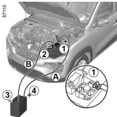
Conecte el cable positivo (+) **A** al terminal (+) **1** de la batería descargada y luego al terminal (+) **4** de la batería que suministra la corriente.
