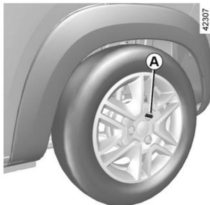
Ajuste la rueda de repuesto o la rueda reparada y alinee uno de los orificios de fijación con el pasador de fijación auxiliar **A** situado en el eje.
