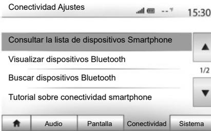
Puede gestionar los dispositivos conectados a su sistema multimedia en cualquier momento a través de «Ajustes» > «Conectividad Ajustes».
