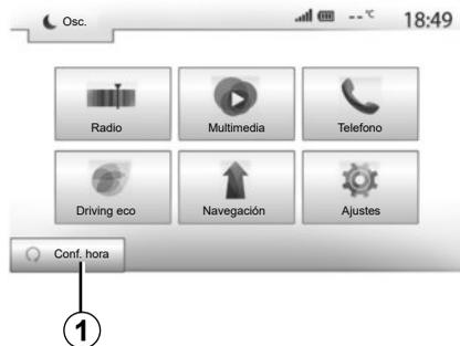
Cuando está instalada, esta función permite programar el motor para su arranque a distancia con el fin de calentar o ventilar el habitáculo hasta 24 horas antes de utilizar el vehículo. Ajuste el nivel de calefacción requerido (temperatura, deshielo) antes de programar la función. La configuración y la programación se realizan a través de la pantalla multimedia.
