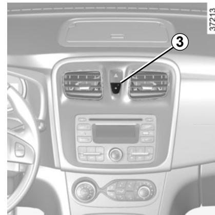
Cuando condena las puertas, el testigo permanece encendido y después se apaga.
