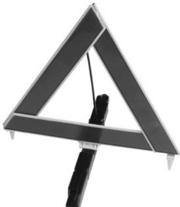
Cuando utilice el triángulo de advertencia, encienda las luces de emergencia y coloque el triángulo aproximadamente a 50 metros antes del vehículo para avisar a los vehículos de que el vehículo está detenido.
