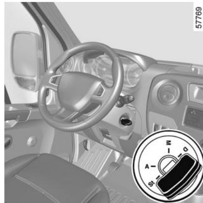
Gire la llave de contacto a la posición de "Encendido" M y manténgala hasta que se apague el testigo de
