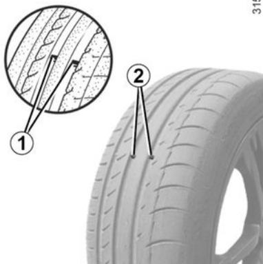
Los neumáticos deben estar en buen estado y las bandas de rodadura deben tener suficiente profundidad; los neumáticos homologados por nues-
