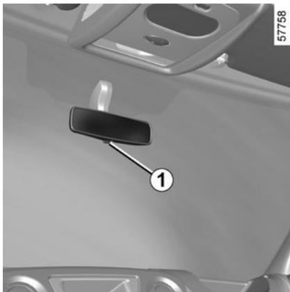
El retrovisor interior es orientable. En conducción nocturna, y para evitar que le deslumbren los faros de los vehículos que circulan por detrás, accione la palanquita **1** situada detrás del espejo retrovisor.
