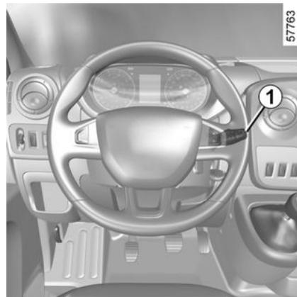
**Con el contacto puesto**, tire de la palanca 1 hacia usted y después libérela.
