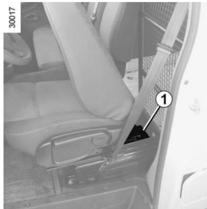
El kit de herramientas **1** se encuentra debajo del asiento del conductor. Para sacar el kit de herramientas, desplace hacia delante el asiento y abata el respaldo → **32**.
