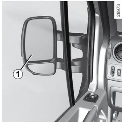
Oriente el espejo **1** para acceder al tornillo. Afloje los tornillos con una herramienta de huella Torx. Saque el intermitente y sustituya la bombilla **2**.
