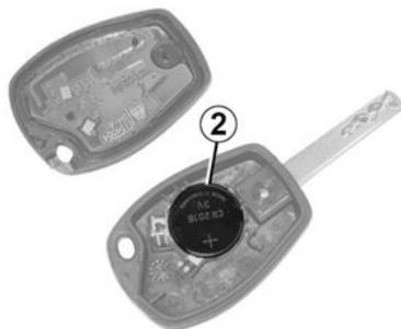
Sustituya la pila **2** respetando la polaridad grabada en la tapa.
