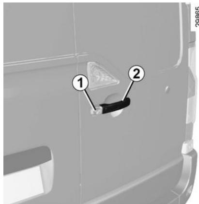
Desbloquee la puerta **1** con la llave o, si el vehículo está equipado con cierre a distancia, utilice el telemando. Tire de la empuñadura **2** hacia usted y abra la puerta.
