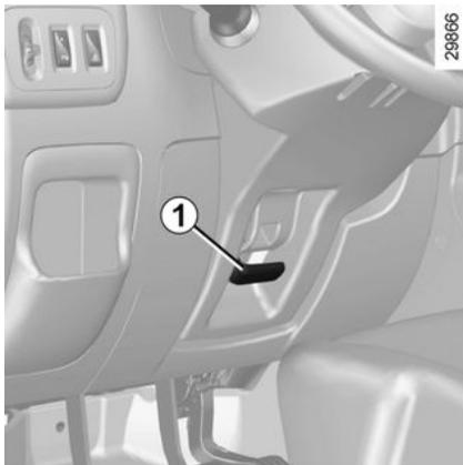
Tire de la palanca **1** y coloque el volante en la posición que desee.
