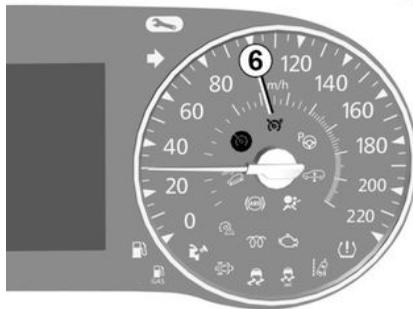
Presione el botón **5** en el lado señalado
