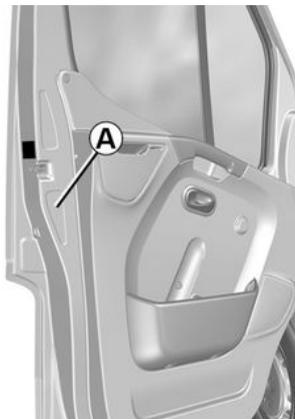
La presión de inflado de los neumáticos figura en la etiqueta **A**.
