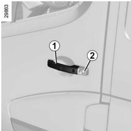
Desbloquee la puerta equipada con cerradura **2** utilizando la llave.
