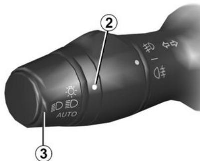
Las luces diurnas se encienden automáticamente al arrancar el motor, sin necesidad de accionar la manecilla **1**, y se apagan al desconectar el motor.
