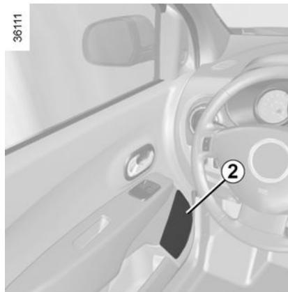
Suelte la tapa **2** utilizando, por ejemplo, un destornillador plano.
