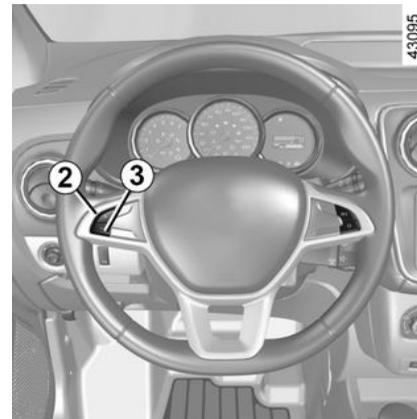
Cuando una velocidad de regulación es memorizada y la regulación está activada, puede usted levantar el pie del pedal del acelerador.
