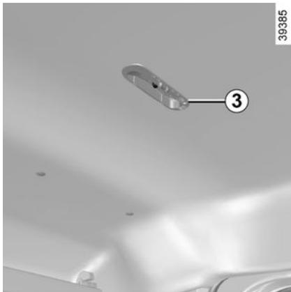
Suelte el difusor **3** utilizando, por ejemplo, un destornillador plano. Saque la lámpara.
