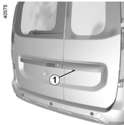
Al meter la marcha atrás, la cámara **1** transmite una vista del entorno trasero del vehículo a la pantalla multimedia **2**, acompañada de unas líneas auxiliares fijas.
