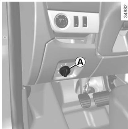
El mando **A** permite corregir la altura de los faros en función de la carga.
