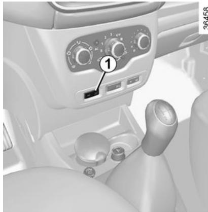
La función limitador de velocidad queda interrumpida cuando actúa en el contactor **1**, en este caso la velocidad limitada no se memoriza. El
