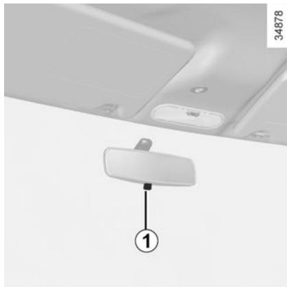
El retrovisor interior es orientable. En conducción nocturna, para no ser deslumbrado por los faros del vehículo que le sigue, bascule la palanca **1**.
