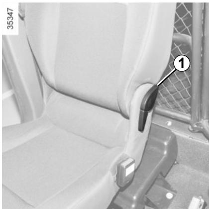
Según el vehículo, el asiento del pasajero delantero puede colocarse en posición bandeja, abatirse o desmontarse para permitir el transporte de objetos voluminosos.
