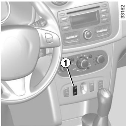
El limitador de velocidad es una función que le permite escoger y definir una velocidad máxima de circulación, llamada **velocidad limitada** y le ayuda a mantenerse por debajo de esa velocidad seleccionada.
