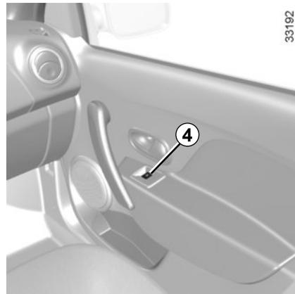
sión sobre el interruptor se oirá un clic, que acciona la segunda etapa. En este caso el cristal sube o baja automáticamente, sin que sea necesario mantener el interruptor accionado.
