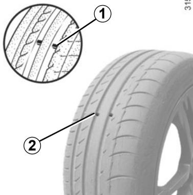
Cuando el relieve del dibujo se haya desgastado hasta el nivel de los salientes-testigo, **éstos se hacen visibles 2: es entonces** necesario sustituir los neumáticos puesto que la profundidad del dibujo es, tan sólo, **de 1,6 mm y dará lugar a una adherencia deficiente en carreteras mojadas.**
