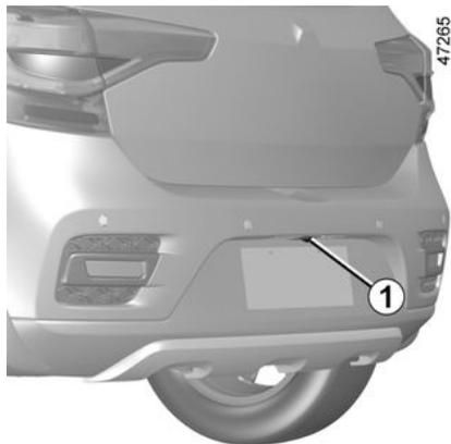
Segun el vehículo, al meter la marcha atrás (y hasta unos 5 segundos después de meter otra marcha), la cámara **1** transmite una vista del entorno trasero del vehículo en la pantalla táctil **2** con una línea auxiliar fija.
