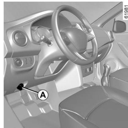
Según vehículo, se puede usar el mando **A** para ajustar la altura de los faros según la carga del vehículo.
