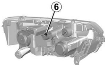
Según vehículo, los faros se deben ajustar manualmente en función de la distribución de la carga en el vehículo.
