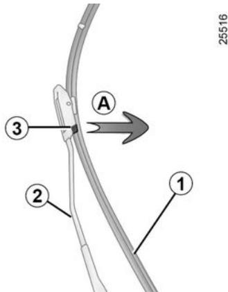
Con las escobillas en la posición de reposo y el contacto apagado, levante el brazo del limpiaparabrisas **2**, presione la lengüeta **3** (movimiento **A**) y empuje la escobilla hacia arriba hasta liberar el conjunto.
