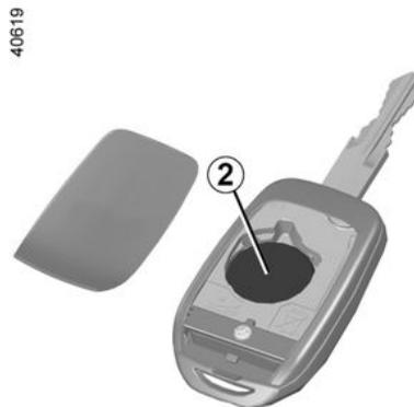
Sustituya la pila **2** respetando la polaridad grabada en la tapa.
