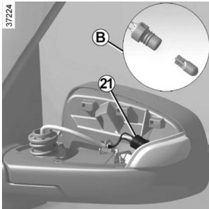
Desconecte el portalámparas del repetidor **21**, como se indica en **B**, y sustituya la lámpara.
