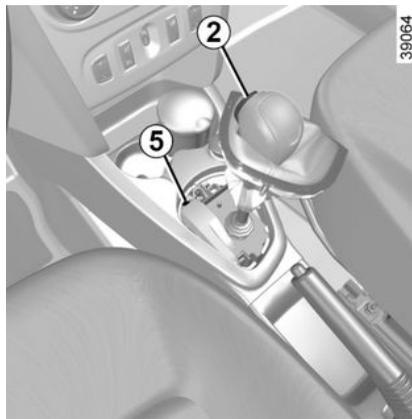
**Al poner el vehículo en marcha**, si la palanca se queda bloqueada en **P** al pisar el pedal de freno, existe la posibilidad de liberarla manualmente. Para ello, suelte la base de la palanca, pase una herramienta (varilla rígida) por la ranura **5** y pulse simultáneamente el botón **2** para desbloquear la palanca.
