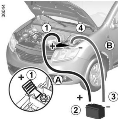
Fije el cable positivo (+) **A** en el borne (+) **1** de la batería descargada, después en el borne (+) **2** de la batería que suministre la corriente.
