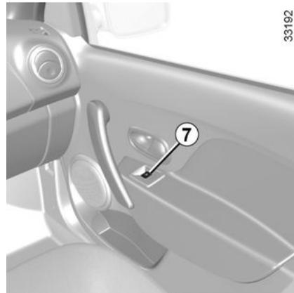
En el modo impulsional, el vidrio sube o baja por completo con solo un toque. Al ejercer un poco más de presión sobre el interruptor se oirá un clic, que acciona la segunda etapa. En este caso el vidrio sube o baja automáticamente, sin que sea
