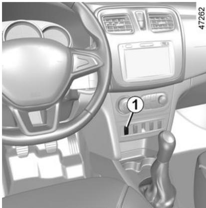
La función regulador de velocidad queda interrumpida cuando usted actúa en el contactor **1**, en este caso la velocidad no queda memorizada. El
