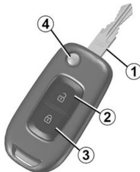
1. Llave codificada del contactor de arranque y de las puertas.
