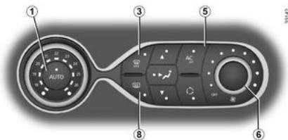
En modo automático, el sistema controla la puesta en marcha o la parada del aire acondicionado en función de las condiciones climatológicas exteriores.
