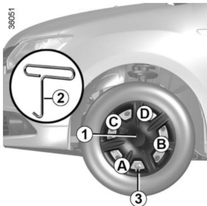
Retire el embellecedor con la llave **2**, introduciéndola en el orificio de la válvula **3**.
