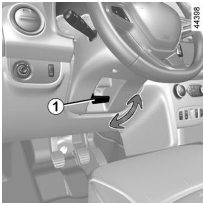
Según el vehículo, la posición del volante es regulable en altura.
