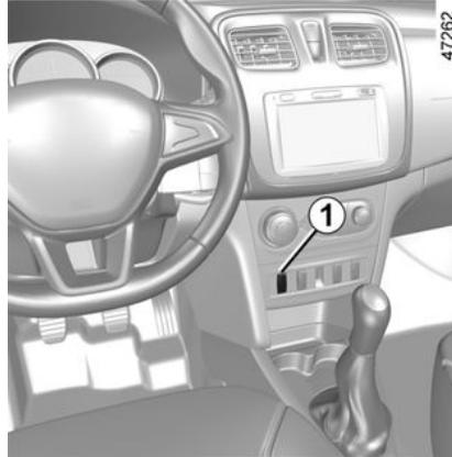
La función limitador de velocidad queda interrumpida cuando actúa en el contactor **1**, en este caso la velocidad limitada no queda memorizada. El apagado del testigo
