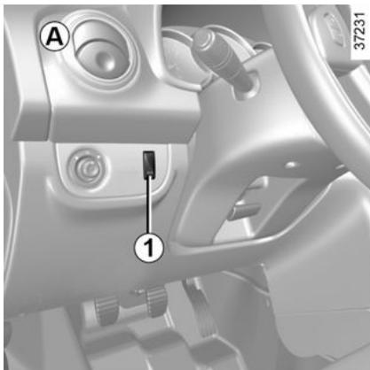
El sistema se puede activar/desactivar mediante una presión prolongada en el contactor **1**.
