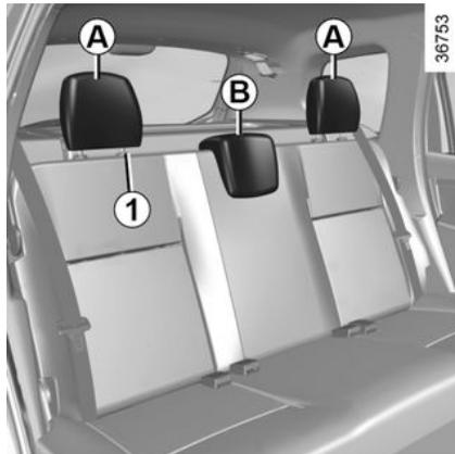
Los apoyacabezas **A** y **B** disponen de una sola posición de reglaje. Levante el apoyacabezas hasta que el botón **1** quede bloqueado.
