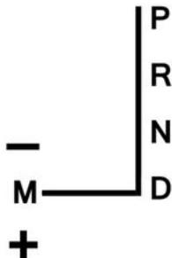
Con la palanca de selección en la posición **D**, lleve la palanca hacia la izquierda hasta la posición **M**. Impulsiones sucesivas en la palanca permiten cambiar de velocidad manualmente :
