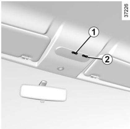
El interruptor **1** activa la luz central del techo. Además de la función de encendido y apagado, es posible activar la iluminación abriendo una de las puertas.
