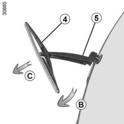
Con el contacto cortado, levante el brazo del limpialuneta **5**. Gire la escobilla **4** hasta encontrar resistencia (movimiento **B**). Tire de la escobilla (movimiento **C**) para liberarla.
