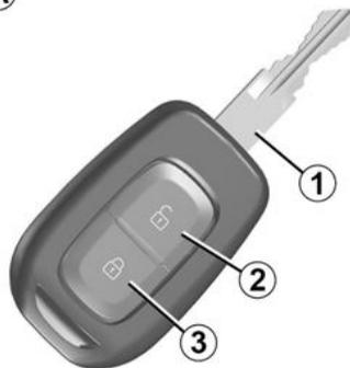
1. Llave codificada del contactor de arranque y de las puertas.
