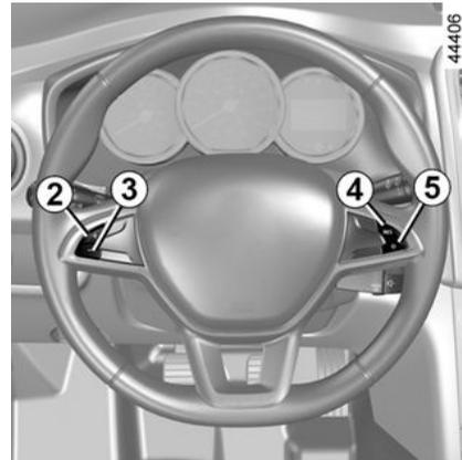
La función de limitador de velocidad quedará en stand-by cuando usted actúe en el contactor **5** (O). En este caso, la velocidad limitada permanece memorizada y el mensaje « MEM » acompañado de la velocidad
