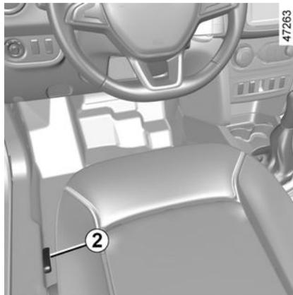
Para abrir el tapón del depósito de combustible **A**, tire del mando **2** que hay a la izquierda del asiento del conductor.
