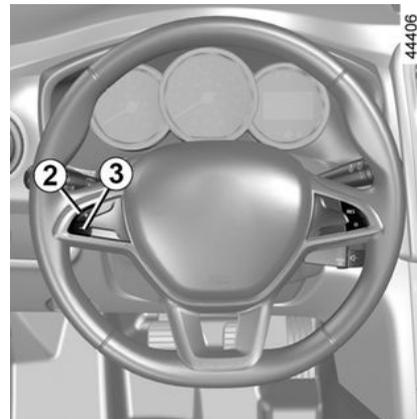
Cuando una velocidad de regulación es memorizada y el modo está activo, el conductor podrá levantar el pie del acelerador.
