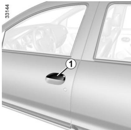
Puertas desbloqueadas (➔ 23), coloque la mano debajo de la empuñadura **1** y tire hacia usted.
