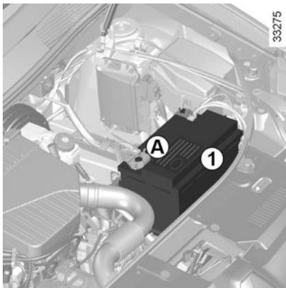
La batería **1** no necesita mantenimiento.
