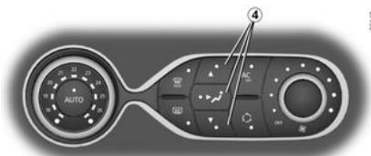
Pulse alguna de las teclas **4**. El testigo integrado de la tecla seleccionada se enciende.
