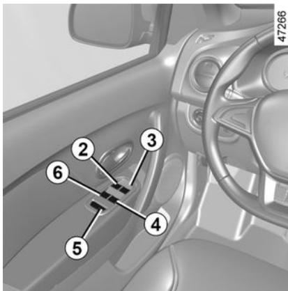
Pulse o tire del contactor de un vidrio para bajarlo o subirlo hasta la altura deseada : los vidrios traseros no descienden completamente.
