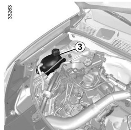
Con el motor apagado y el vehículo en un suelo horizontal, el nivel en frío debe situarse entre las marcas
