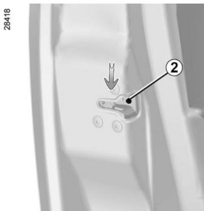
En caso de una avería eléctrica en la que no sea posible realizar el bloqueo automático de las puertas, podrá bloquearlas individualmente a través de la palanca **2**.
