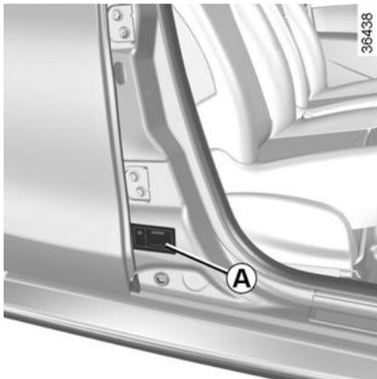
La presencia de la placa del constructor **A** depende del vehículo.
