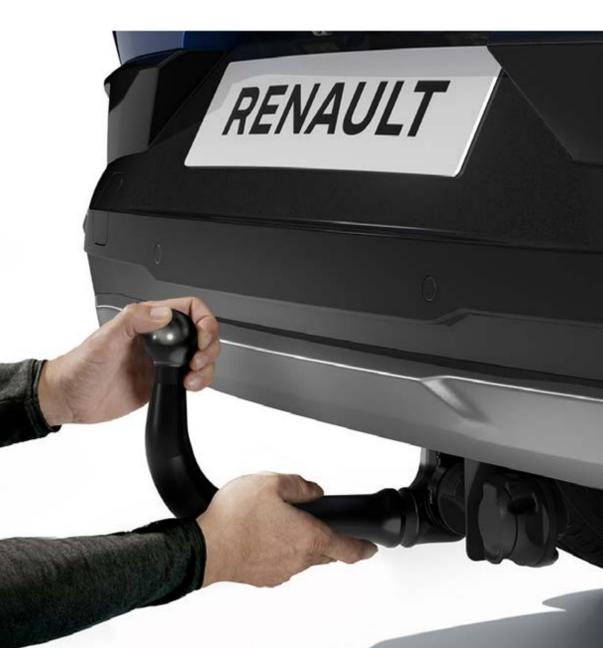
Werkzeuglos abnehmbare Anhängerkupplung
