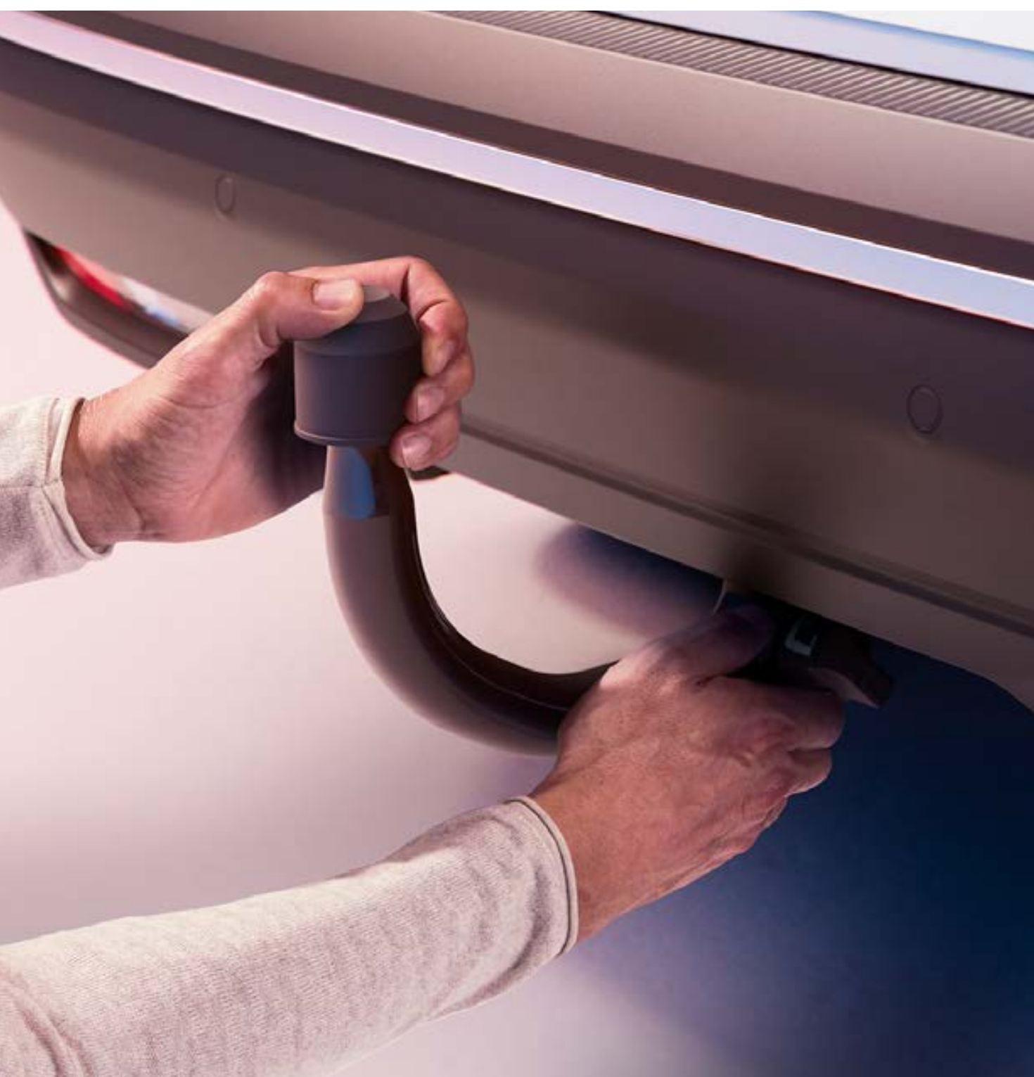
Werkzeuglos abnehmbare Anhängerkupplung
