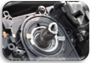
Hohle Lenksäule, abnehmbar hinter Dem Lenkrad
