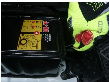
Manuelles Lösen der Parkbremse
