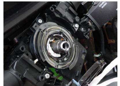
Lenksäule, hohl, teilbar hinter dem Lenkrad
