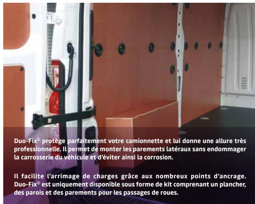
Duo-Fix® protège parfaitement votre camionnette et lui donne une allure très professionnelle. Il permet de monter les parements latéraux sans endommager la carrosserie du véhicule et d'éviter ainsi la corrosion.
