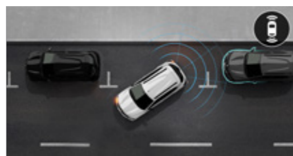
sensor de ré O sensor de ré emite um alerta sonoro quando algum objeto está próximo ao veículo, oferecendo maior segurança durante as manobras.
