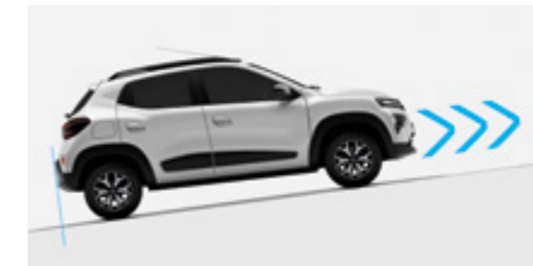
assistente de partida em rampa O assistente de partida em rampa (HSA) mantém o veículo estático em inclinações, dando tempo para que você dê partida em segurança, sem ir para trás.
