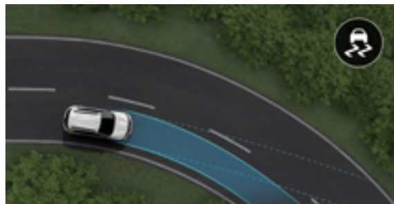
sistema eletrônico de estabilidade (ESP) O ESP é um sistema eletrônico de controle que permite corrigir a trajetória de um automóvel, evitando que ele saia da estrada. Para dirigir com total segurança em todos os momentos.
