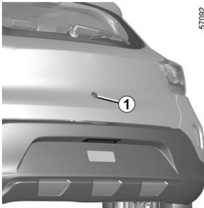
Dependendo do veículo, ao engatar a marcha à ré (e por até cerca de 5 segundos após trocar para outra marcha), a câmara **1** mostra uma imagem dos arredores da traseira do veículo na tela de toque **2**, acompanhada de um medidor fixo.
