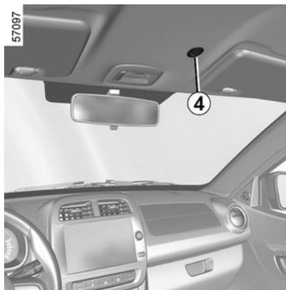
Em veículos equipados com sistema multimídia, use o microfone **4**
