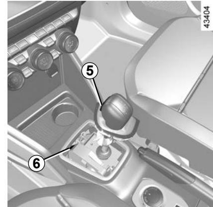
Ao desligar, se a alavanca ficar bloqueada na posição **P** enquanto você apoia o pedal do freio, é possível desbloqueá-la manualmente.
