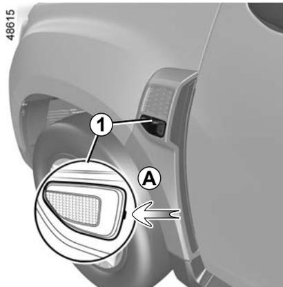
Desencaixe a luz indicadora **1** com uma ferramenta do tipo chave de fendas, ou semelhante, aplicada em **A**, para manusear a luz indicadora na direção do exterior do veículo.
