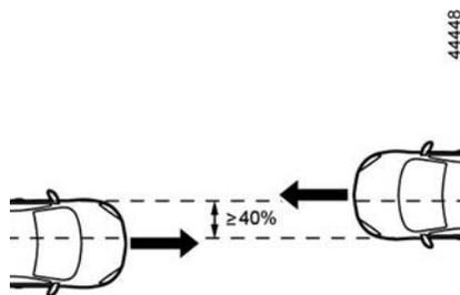
**Numa colisão frontal** com outro veículo de categoria equivalente ou superior, com uma zona de colisão igual ou superior a 40%, em que a velocidade de ambos os veículos seja igual ou superior a **40 km/h**.
