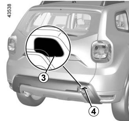
Estes pontos de reboque só podem ser utilizados em tração; em nenhum caso, devem servir para levantar direta ou indiretamente o veículo.
