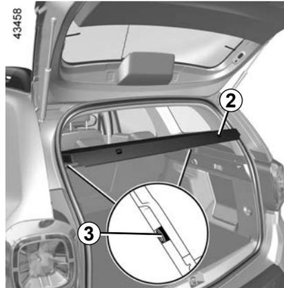
Levante o tampão **2** a uma altura intermédia para desencaixar as fixações **3** situadas em cada lado do tampão.
