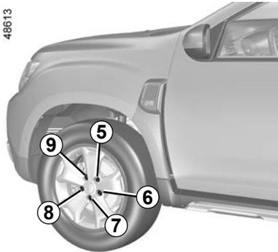
Aperte os parafusos, assegurando-se de que a roda esteja bem encostada ao cubo, e baixe o macaco.
