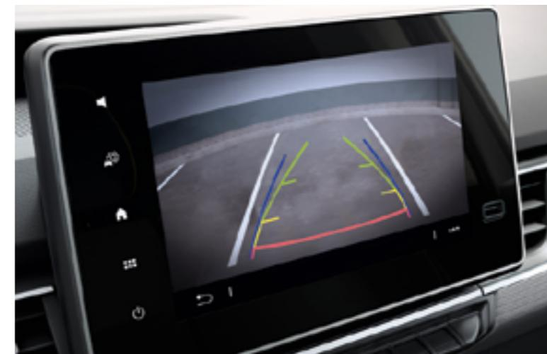
**Câmera de estacionamento.** Transmite para a tela Easy Link uma visão do espaço atrás do veículo quando a ré é acionada. As linhas de orientação facilitam e permitem que realize suas manobras em segurança.
