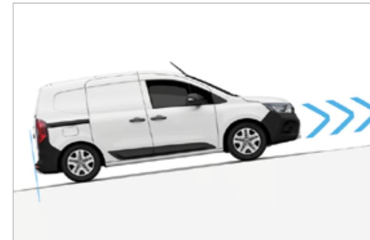
**Assistente de partida em rampa.** O assistente de partida em rampa, associado ao ESP, permite que a pressão de frenagem se mantenha automaticamente durante 2 segundos para que tenha tempo necessário para soltar o pedal do freio e acelerar. O sistema é ativado quando a inclinação do piso é superior a 3%.
