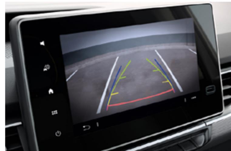
**Câmera de estacionamento.** Transmite para a tela Easy Link uma visão do espaço atrás do veículo quando a ré é acionada. As linhas de orientação facilitam e permitem que realize suas manobras em segurança.
